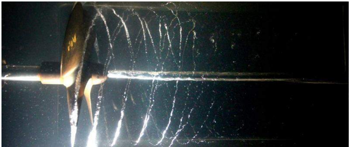
Fig. 60: Cavitação ocorrendo em hélice subaquática
