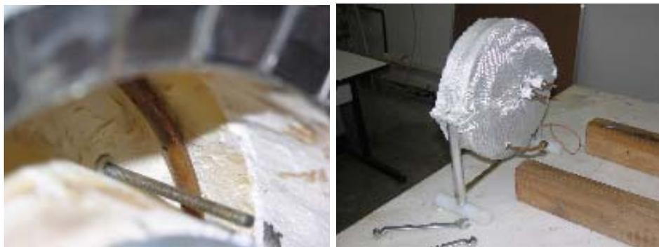
Figura 4.5: Na foto da esquerda, o detalhe do tubo por onde o gás é injetado no sistema. À direita, vemos os passadores de corrente para o catodo e a tubulação do gás propelente.
