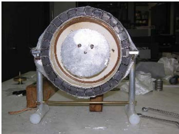
Figura 4.4: Suporte e tampão de alumínio do cilindro interior da fonte de plasma. Além dessas estruturas, vê-se na foto o tubo por onde o gás é injetado no sistema e os ímãs permanentes de ferrita utilizados no protótipo.
