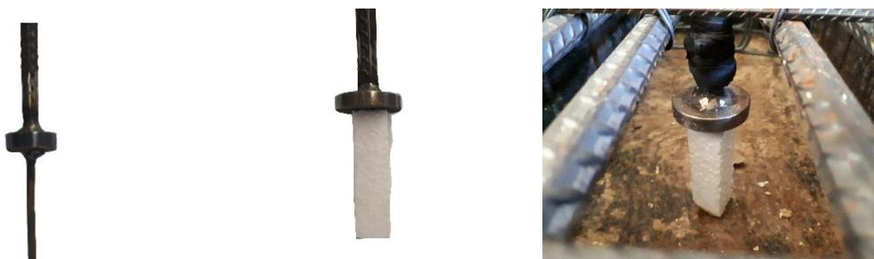
Figura 3.15 – Detalhe construtivo para medição de deslocamento do LVDT 1 (SILVA, 2018)
