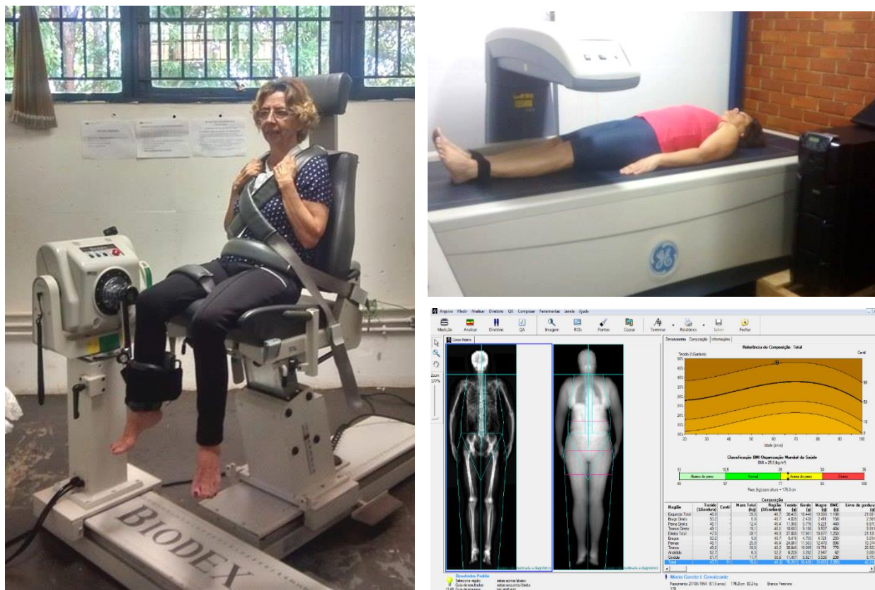
Figura 1. Registro fotográfico da avaliação da qualidade muscular. À esquerda, avaliação da força dos extensores do joelho do membro inferior dominante. À direita, mensuração da massa magra da perna dominante.
