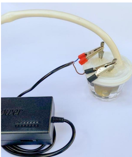
Figura 15 – Conexão dos fios condutores na fonte e nas colheres
