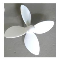
Figura 21 – Rotor impresso empregado nos ensaios em túnel de vento.
