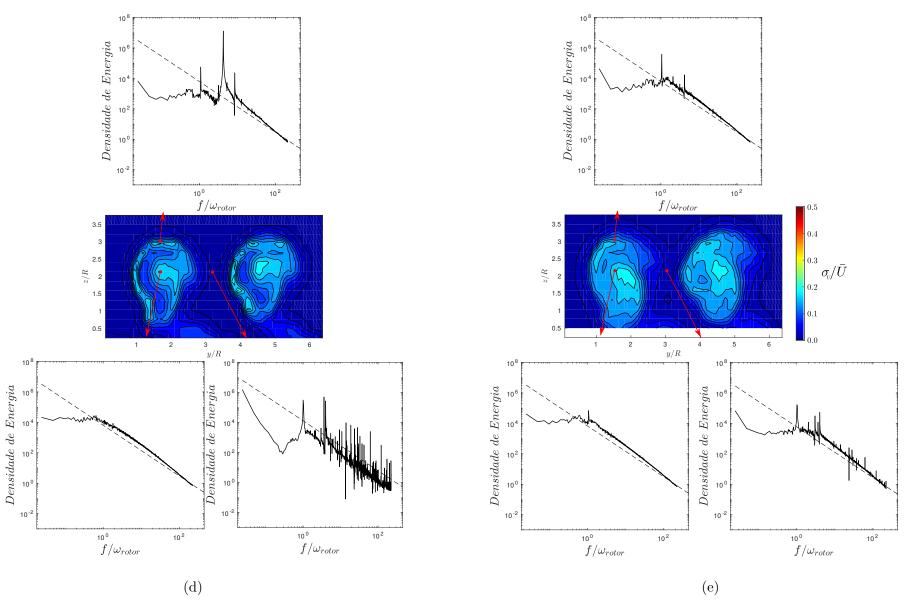
Figura 62 – Evolução da turbulência para 2 turbina com W/R=3 nos planos jusante a (a) x/R= (b)x/R= (c) x/R= (d)x/R= e espectro de densidade de energia para o centro do rotor e ponta de pá. Em cada gráfico a lei do -5/3 de Kolmogorov é indicada pela linha pontilhada.
