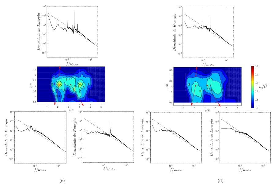
Figura 61 – Evolução da turbulência para 2 turbina com W/R = 2 nos planos jusante a (a) x/R = 2 (b)x/R = 4 (c) x/R = 8 (d)x/R = 12 e espectro de densidade de energia para o centro do rotor e ponta de pá. Em cada gráfico a lei do -5/3 de Kolmogorov é indicada pela linha pontilhada.
