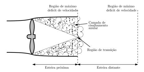
Figura 6 – Representação da esteira aerodinâmica de uma turbina de eixo horizonta
