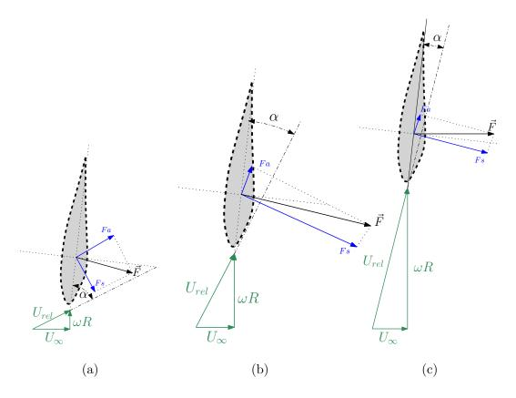
Figura 3 – Triângulo de velocidade para o rotor de eixo horizontal para diferentes pontos de operação. Comportamento das forças de sustentação (Fs) e arrasto (Fa) para representações valores de TSR (a) baixo (b) ótimo (c) elevado. Adaptado de (YANG; SARKAR; HU, 2011).
