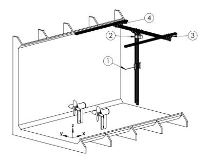
Figura 32 – Configuração experimental do anemômetro de fio quente. 1: Sonda do anemômetro; 2: motor de passo para movimento na coordenada z; 3: motor de passo para movimento na coordenada y; 4: motor de passo para movimento na coordenada x.
