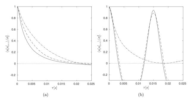
Figura 46 – Função autocorrelação para os sinais de velocidade aferidos no centro do rotor (a) e na ponta de pá (b). Cada curva representa uma distância distinta dos planos x/R = 3 (—), x/R = 8(---) e x/R = 12(----).
