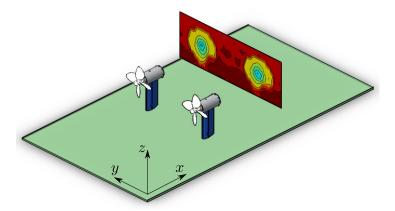
Figura 55 – Medição de velocidades no plano jusante x/R = 3 a jusante a turbina.
