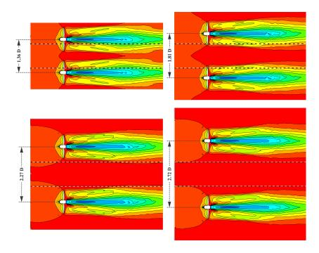
Figura 50 – Distribuição de velocidade para diferentes W do arranjo. As linhas pontilhadas representam o espaçamento destinado para a inserção do terceiro rotor.
