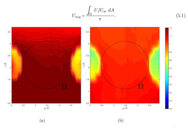
Figura 66 – Comparação da distribuição da velocidade entre as turbinas no plano x/R = 2 para (a) arranjo duplo W = 4R e (b) arranjo triangular W = 4R, L = 4R. A circunferência de raio unitário é sobreposta nos dois gráficos representando a área da última turbina.
