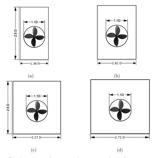
Figura 16 – Domínios empregados para simulação com condições de contorno periódicas. Cada imagem representa um afastamento entre rotores, correspondendo à distância entre cada rotor de (a) 1,36 D (b) 1,81 D (c) 2,27 D (d) 2,72 D.
