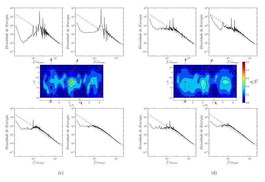
Figura 75 – Evolução da turbulência para 3 turbinas com W/R = 4 e L/R = 4 nos planos jusante a (a) x/R = 0 (b) x/R = 3 (c) x/R = 10 (d) x/R = 12 e espectro de densidade de energia para o centro do rotor e ponta de pá. Em cada gráfico a lei do -5/3 de Kolmogorov é indicada pela linha pontilhada.
