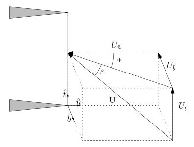
Figura 31 – Componentes de velocidade do anemômetro para sonda unidimensional, adaptado de (LEKAKIS, 1996). O sistema de coordenadas é apresentado como:  $\hat{n}$  sendo a componente corresponde a coordenada normal ao fio e ao eixo da sonda,  $\hat{b}$  a componente corresponde a coordenada normal ao fio e paralelo ao eixo da sonda e  $\hat{t}$  a componente tangencial ao fio.
