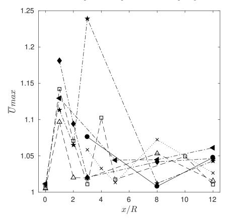
Figura 67 – Evolução dos máximos valores de velocidade para (•) 1 turbina e 3 turbinas com a distância entre elas de ( $\bigstar$ ) W=2R/L=4R, ( $\Box$ ) W=2R/L=5R, (•) W=3R/L=4R, (×) W=3R/L=0R, (•) W=4R/L=3R e ( $\Delta$ ) W=4R/L=4R.
