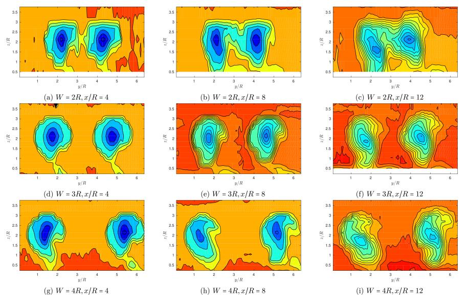
Figura 57 – Campo de velocidade transversal do escoamento de duas turbinas, planos em x/R = 4, 8 e 12 e W = 2R, 3R e 4R.
