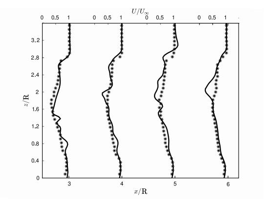
Figura 39 – Perfis de velocidade média no plano central a jusante da turbina. (–) LES (\*) Anemometria de fio quente.
