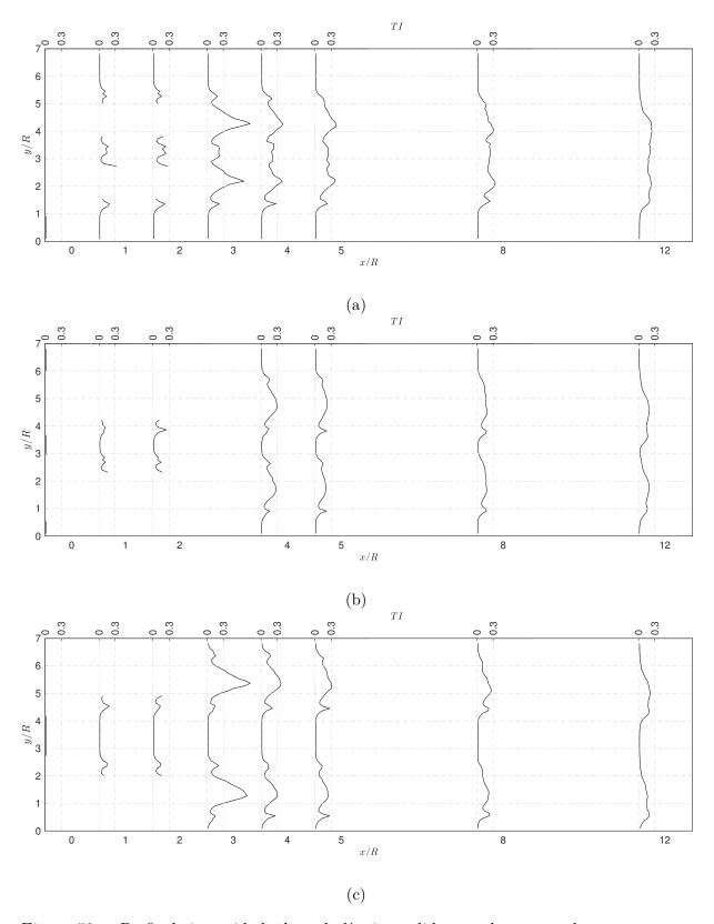
Figura 59 — Perfis de intensidade de turbulência medidos no plano central ao rotor com o anemômetro para o caso de duas turbinas com a distância (a) W = 2R, (b) W = 3R e (c) W = 4R. A ausência de dados em alguns dos perfis mostrados indicam regiões de impossibilidade de medição devido à presença física do rotor ou torre.
