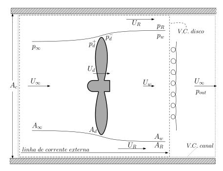
Figura 4 – Disco atuador para turbinas confinadas em canais.
