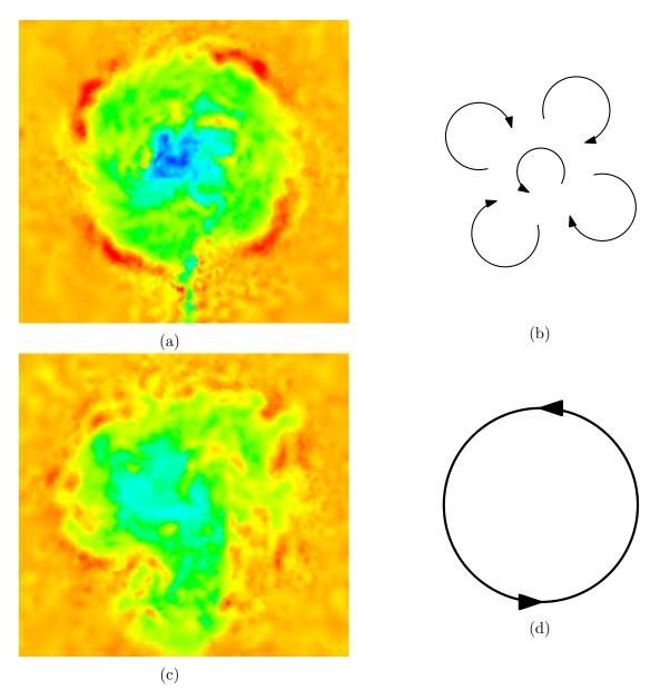
Figura 45 – Visualização do desenvolvimento dos vórtices de ponta de pá e raiz, por meio dos resultados do campo de velociade média obtidos via simulação LES. Contorno de velocidade média para o plano de (a) x/R = 3 e (c) x/R = 8. Modelo de vórtices para (b) x/R = 3 e (d) x/R = 8.
