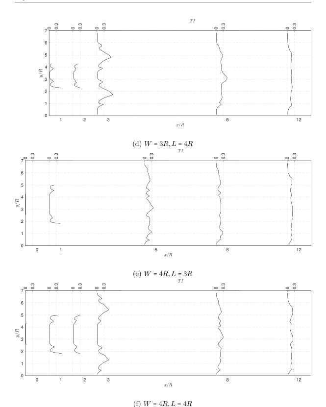
Figura 68 – Perfis de intensidade de turbulência aferidos no plano central ao rotor com o anemômetro para o arranjo com três turbinas seguindo as coordenadas (a)W = 2R, L = 4R, (b)W = 2R, L = 5R, (c)W = 3R, L = 4R, (d)W = 4R, L = 0R, (e)W = 4R, L = 3R, (f)W = 4R, L = 4R. A ausência de dados em alguns dos perfis mostrados indicam regiões de impossibilidade de medição devido à presença física do rotor ou torre.
