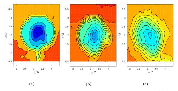
Figura 42 – Contorno de velocidade média para 1 turbina para os planos jusante (a)x/R = 3, (b)x/R = 8 e (c)x/R = 12.
