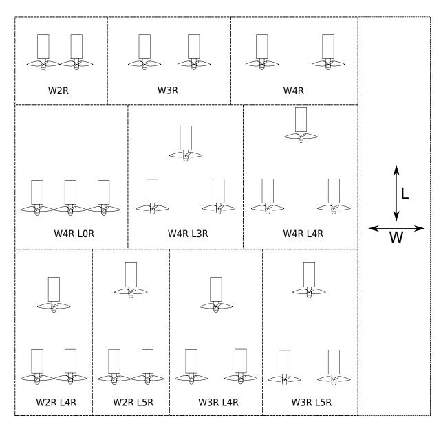
Figura 35 – Arranjos ensaiados em túnel de vento.
