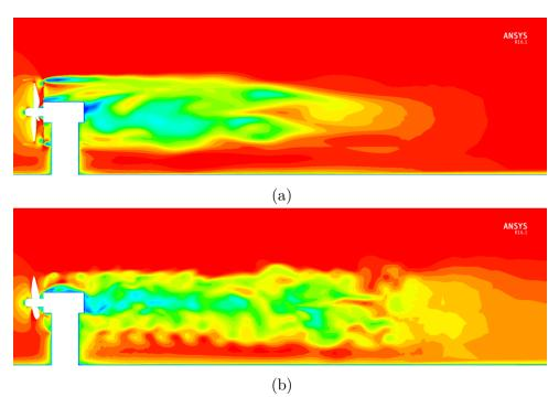
Figura 38 – Comparação da velocidade no plano médio para cálculo numérico com diferentes modelos de turbulência. (a) Escoamento médio obtido com o RANS (b) Escoamento instantâneo computado com o LES.
