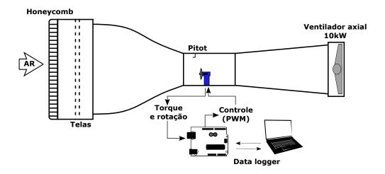
Figura 29 – Configuração experimental para o ensaio do coeficiente de potência.
