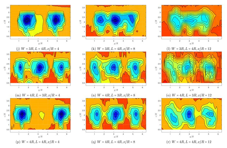
Figura 65 – Distribuição da velocidade para os arranjos com três turbinas.
