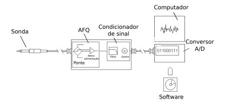
Figura 30 – Esquema dos elementos do anemômetro de fio quente, adaptado de (J $\emptyset$ R-GENSEN, 2002)
