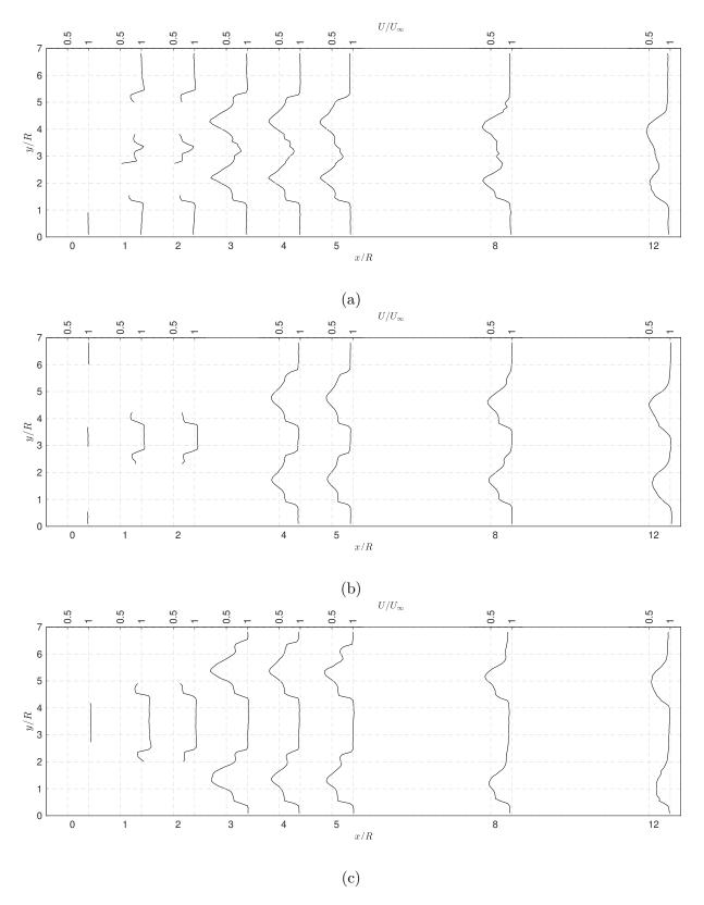
Figura 56 – Perfis de velocidade adimensional aferidos no plano central ao rotor com o anemômetro para o caso de duas turbinas com a distância (a) W = 2R, (b) W = 3R e (c) W = 4R. A ausência de dados em alguns dos perfis mostrados indicam regiões de impossibilidade de medição devido à presença física do rotor ou torre.
