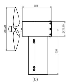
Figura 22 – Modelo reduzido 1:10 da turbina HK10. (a) Foto da montagem no túnel de vento.(b)Desenho técnico com dimensões em milímetros.
