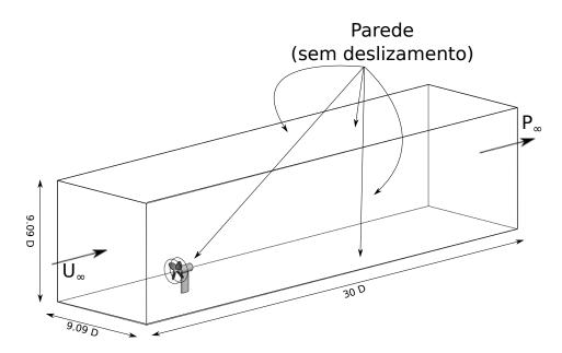
Figura 17 – Domínio e condições de contorno aplicadas na modelagem numérica do experimento em túnel de vento. Onde o diâmetro do modelo reduzido é D = 220mm.
