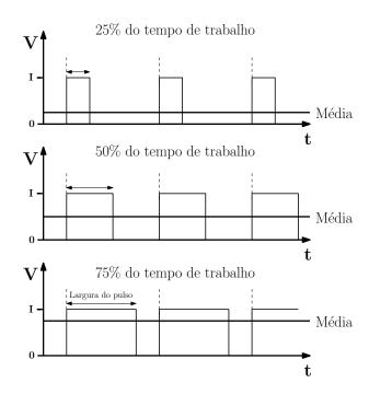
Figura 27 – Técnica de modulação PWM para três tempos de trabalhos distintos. Os gráficos representam a tensão de entrada no transistor em função do tempo, onde quando a amplitude da onde é máxima, o transistor é ligado, e quando mínima o circuíto se abre.
