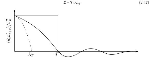
Figura 10 – Função autocorrelação do sinal de velocidade U(t).
