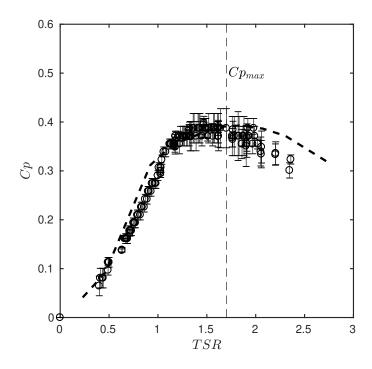
Figura 36 – Coeficiente de potência para turbina HK10.(- -) CFD RANS SST. (()) Experimentos em túnel de vento.
