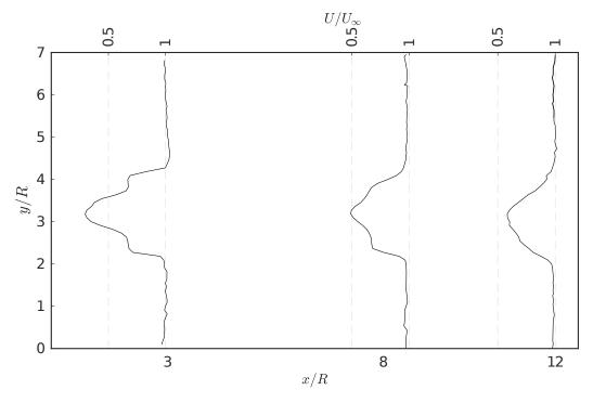
Figura 41 – Perfis horizontais de velocidades para o escoamento de 1 turbina.
