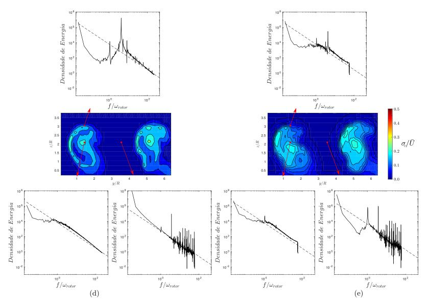
Figura 63 – Evolução da turbulência para 2 turbina com W/R=4 nos planos jusante a (a) x/R= (b)x/R= (c) x/R= (d)x/R= e espectro de densidade de energia para o centro do rotor e ponta de pá. Em cada gráfico a lei do -5/3 de Kolmogorov é indicada pela linha pontilhada.
