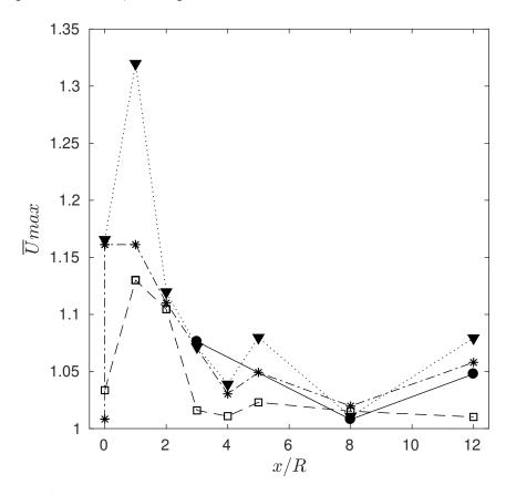
Figura 58 – Evolução dos máximos valores de velocidade. Resultados obtidos para (•) 1 turbina e duas turbinas com a distância entre elas de ( $\square$ ) W = 2R, (\*) W = 3R e ( $\blacktriangledown$ ) W = 4R.
