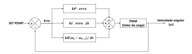
Figura 28 – Diagrama de blocos do sistema de controle PID.
