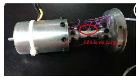
Figura 25 – Foto da montagem do torquímetro acoplado do gerador.
