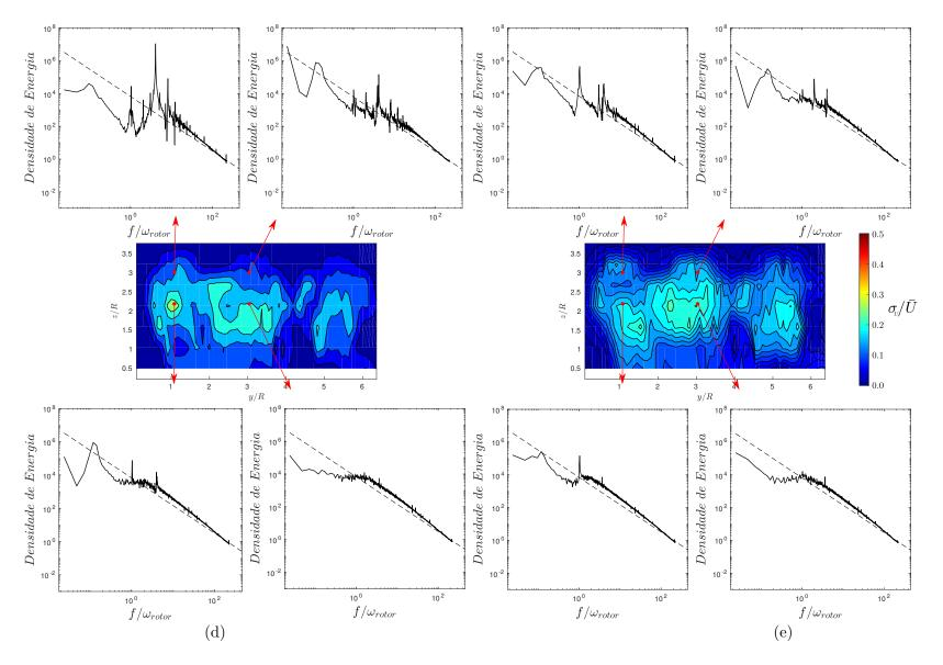
Figura 74 – Evolução da turbulência para 3 turbinas com W/R = 4 e L/R = 3 nos planos jusante a (a) x/R = 0 (b)x/R = 1 (c) x/R = 5 (d)x/R = 10 (e)x/R = 12 e espectro de densidade de energia para o centro do rotor e ponta de pá. Em cada gráfico a lei do -5/3 de Kolmogorov é indicada pela linha pontilhada.
