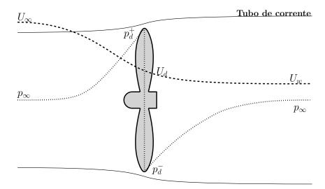
Figura 2 – Ilustração do comportamento da velocidade e pressão no modelo de disco atuador para turbinas de eixo horizontal.
