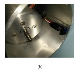
Figura 23 – Sistema utilizado para medição da velocidade de rotação da turbina. (a) Disco reflexivo com abas metálicas para excitação do sensor óptico. (b) Sensor óptico.
