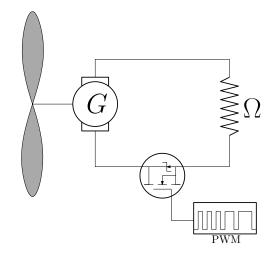
Figura 26 – Circuito resistivo utilizado para controle da rotação da turbina.
