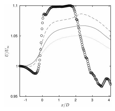
Figura 52 – Velocidade na linha central do arranjo. Distância entre os rotores  $W = (\bigcirc)$  2, 72R, (---)3, 26R, (---)4, 54R,  $(\cdot \cdot \cdot)5$ , 44R
