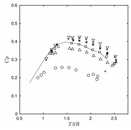
Figura 54 – Coeficiente de potência para a turbina a jusante do arranjo triangular.  $\circ$ :  $W/R = 2,36, +: W/R = 2,72, \triangle: W/R = 3,18, \Box: W/R = 3,46, *: W/R = 3,64, ×: W/R = 4,54, <math>\nabla: W/R = 5,08,$ —: rotor individual. A barra de erro foi omitida para melhor entendimento.
