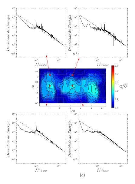
Figura 70 – Evolução da turbulência para 3 turbinas em linha, W/R = 4 e L/R = 0, nos planos jusante a (a) x/R = 3 (b)x/R = 10 (c) x/R = 12 e espectro de densidade de energia para o centro do rotor e ponta de pá. Em cada gráfico a lei do -5/3 de Kolmogorov é indicada pela linha pontilhada.
