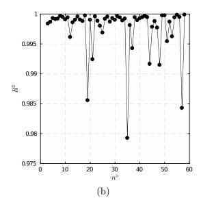
Figura 33 – Resultado para o procedimento de calibração do anemômetro de fio quente.
