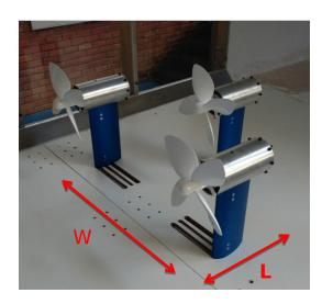
Figura 34 – Arranjo de turbinas no túnel de vento.
