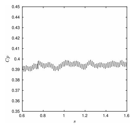
Figura 37 – Variação temporal do coeficiente de potência para o ponto de operação para a simulação com o LES.
