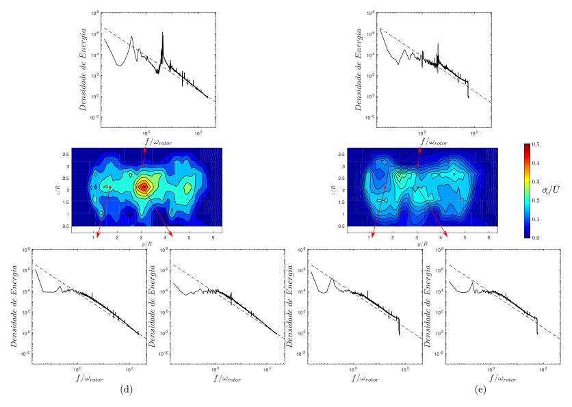
Figura 73 – Evolução da turbulência para 3 turbinas com W/R = 3 e L/R = 4 nos planos jusante a (a) x/R = 1 (b)x/R = 2 (c) x/R = 3 (d)x/R = 10 (e)x/R = 12e espectro de densidade de energia para o centro do rotor e ponta de pá. Em cada gráfico a lei do -5/3 de Kolmogorov é indicada pela linha pontilhada.
