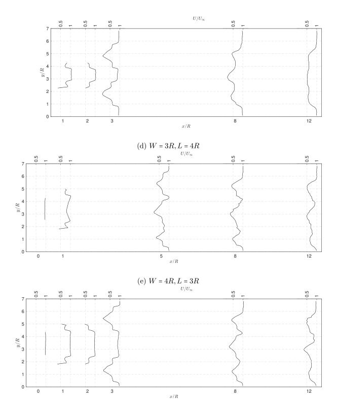
Figura 64 – Perfis de velocidade adimensional aferidos no plano central ao rotor com o anemômetro para o arranjo com três turbinas seguindo as coordenadas (a)W = 2R, L = 4R, (b)W = 2R, L = 5R, (c)W = 3R, L = 4R, (d)W = 4R, L = 0R, (e)W = 4R, L = 3R, (f)W = 4R, L = 4R. A ausência de dados em alguns dos perfis mostrados indicam regiões de impossibilidade de medição devido à presença física do rotor ou torre.
