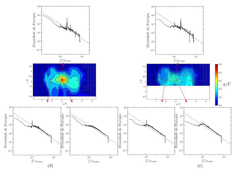
Figura 72 – Evolução da turbulência para 3 turbinas com W/R = 2 e L/R = 5 nos planos jusante a (a) x/R = 1 (b)x/R = 2 (c) x/R = 3 (d)x/R = 10 (e)x/R = 12 e espectro de densidade de energia para o centro do rotor e ponta de pá. Em cada gráfico a lei do -5/3 de Kolmogorov é indicada pela linha pontilhada.
