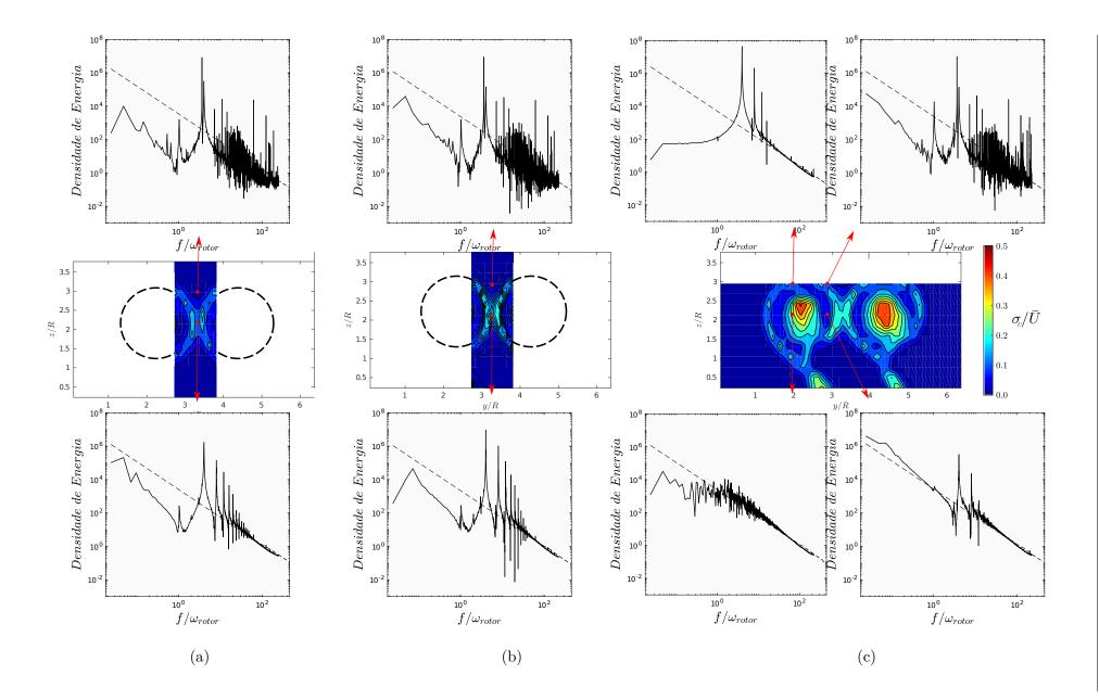
Figura 71 – Evolução da turbulência para 3 turbinas com W/R = 2 e L/R = 4 nos planos jusante a (a) x/R = 1 (b)x/R = 2 (c) x/R = 3 (d)x/R = 8 (e)x/R = 10 e espectro de densidade de energia para o centro do rotor e ponta de pá. Em cada gráfico a lei do -5/3 de Kolmogorov é indicada pela linha pontilhada.
