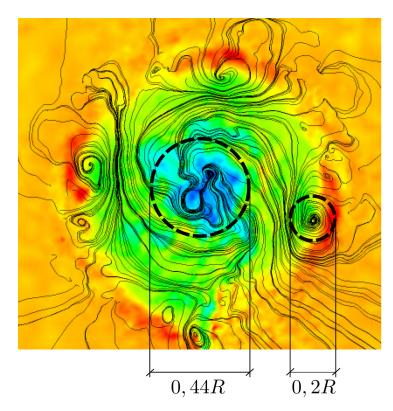
Figura 48 – Comparação das escalas de comprimento integral,  $\mathcal{L}$ , computadas via resultados experimentais do anemômetro de fio quente e simulação LES para o plano x/R=3.
