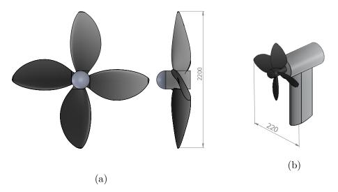
Figura 11 – Modelos geométricos empregadas nos cálculos numéricos, escala em milímetros.
