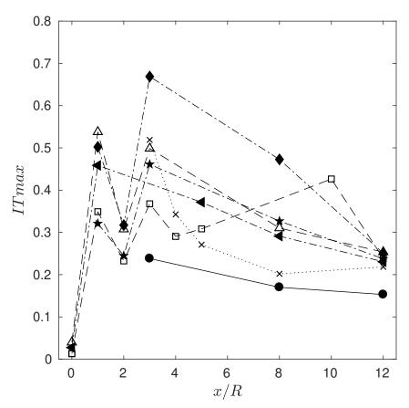
Figura 69 – Evolução dos máximos valores de intensidade de turbulência para (•) 1 turbina e 3 turbinas com a distância entre elas de ( $\bigstar$ ) W = 2R/L = 4R, ( $\square$ ) W = 2R/L = 5R, ( $\spadesuit$ ) W = 3R/L = 4R, (x) W = 3R/L = 0R, ( $\checkmark$ ) W = 4R/L = 3R e ( $\triangle$ ) W = 4R/L = 4R.
