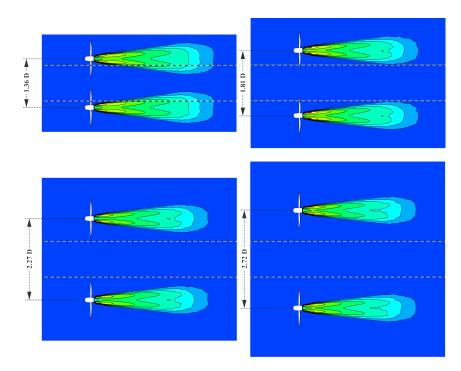
Figura 51 – Intensidade de turbulência para diferentes W do arranjo.
