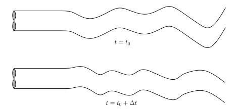
Figura 7 – Fenômeno do serpenteamento da esteira aerodinâmica.
