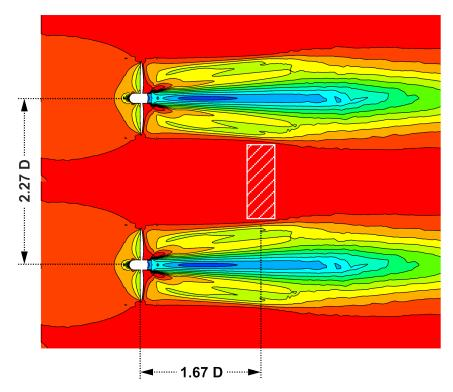
Figura 53 – Melhor posicionamento da terceira máquina para o arranjo triangular, segundo simulações RANS.
