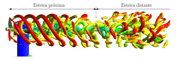
Figura 40 – Visualização do vórtices por meio do parâmetro Q-criterion.
