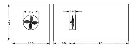
Figura 12 – Domínio numérico aplicado para a análise do rotor livre.
