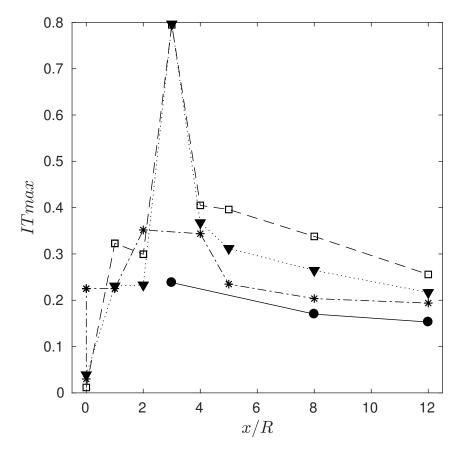
Figura 60 – Evolução dos máximos valores de intensidade de turbulência. Resultados obtidos para ( $\bullet$ ) 1 turbina e duas turbinas com a distância entre elas de ( $\square$ ) W = 2R, (\*) W = 3R e ( $\blacktriangledown$ ) W = 4R.
