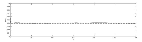
Figura 77 – Convergência da média para o sinal do anemômetro de fio quente com frequência de aquisizão de 10kHz
