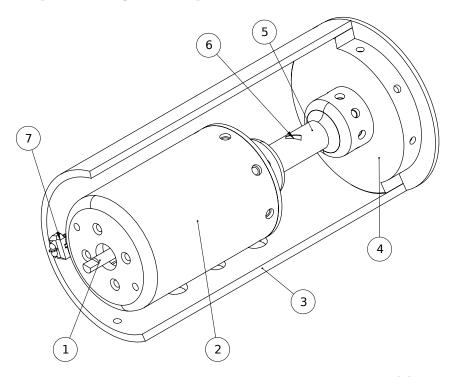
Figura 24 – Esquema dos componentes internos ao modelo reduzido.(1) Eixo do gerador. (2) Suporte do gerador. (3) Casca para proteção do sistema. (4) Tampa de fixação. (5) Cilindro de torção, onde ocorre a deformação devido ao torque do gerador. (6) Par de extensômetros fixos a 45°. (7) Sensor ótico para medição da rotação.
