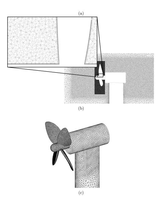
Figura 18 – Malha implementada no estudo numérico do experimento em túnel de vento. (a) Seção transversal do domínio total. (b) Detalhe do subdomínio rotativo.
