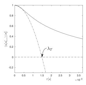
Figura 47 – Representação do ajuste quadrático empregada para identificação do tempo característico de Taylor,  $\lambda_T$ , para o ponto central no plano x/R=3. (—) Função autocorrelação. (-·-·) Ajuste quadrático.
