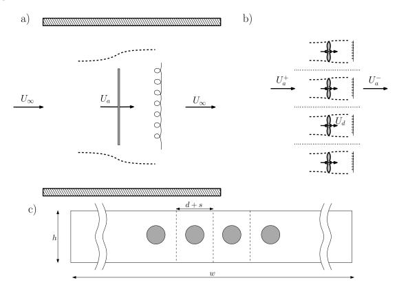
Figura 5 – Representação de uma fazenda hidrocinética de turbinas de eixo horizontal operando em um canal. (a) Escala do arranjo. (b) Escala do rotor. (c) seção transversal do canal. Adaptado de Nishino e Willden (2012).
