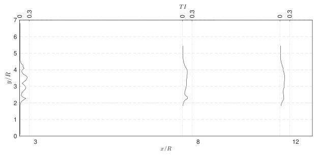
Figura 43 – Perfis horizontais de intensidade de turbulência para o escoamento de 1 turbina.
