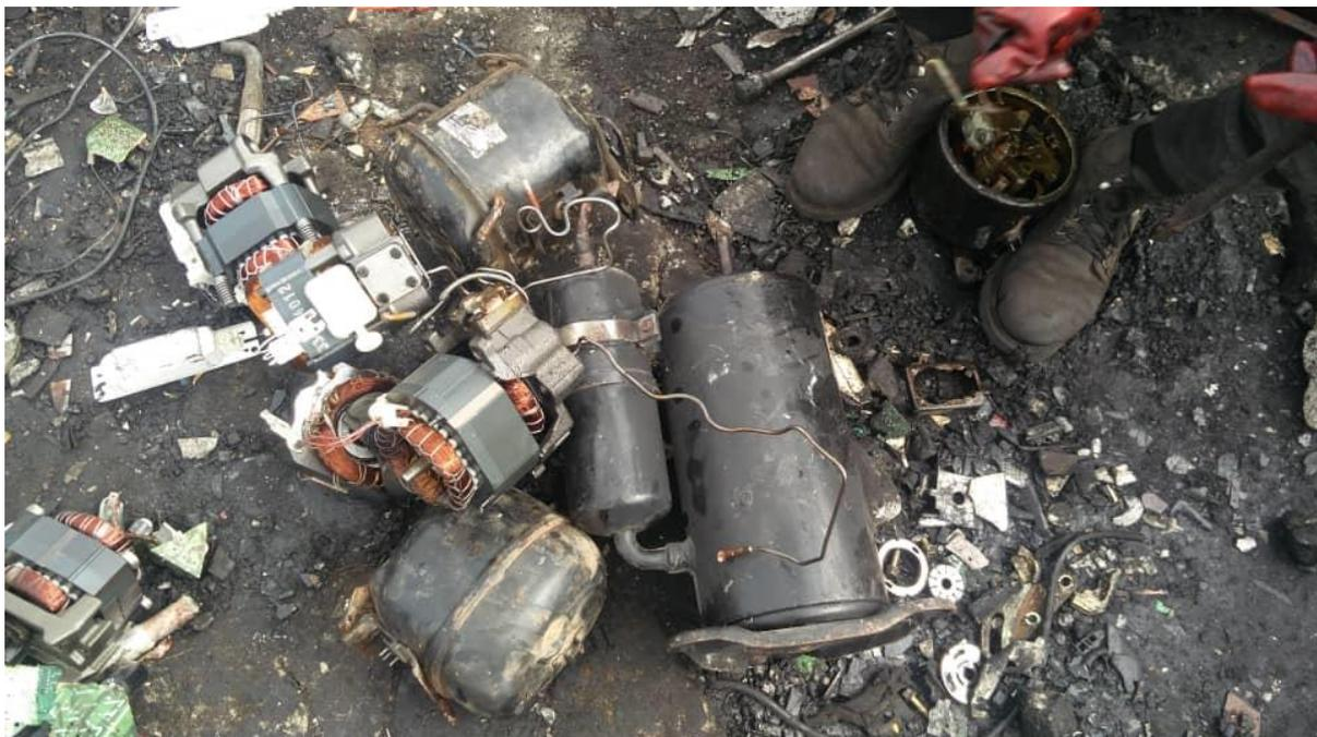
*Figura Anexo 11 — O cobre dentro dos motores.*
