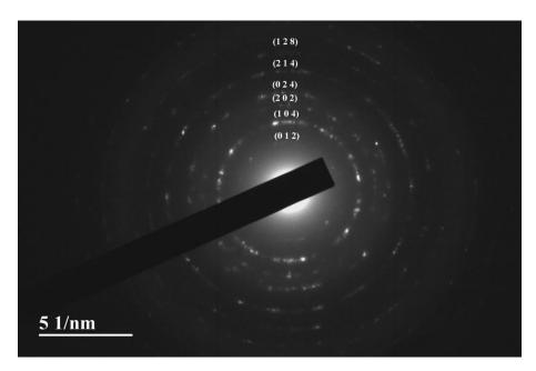
Figura VII. 4. SAED da amostra LSF 40:60 a 500 °C
