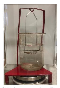
Figura 3.20. Suporte para aferição de massa aparente do monólito poroso imerso no líquido no momento em que se analisa uma amostra
