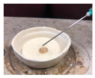
Figura 4.29. *Scaffold* de Z10-Pch sendo impregnado de LSF 60:40
