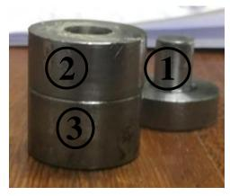
Figura 3.4. Moldes metálicos para prensagem de eletrólito de 1 cm de diâmetro
