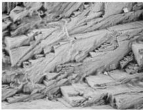
Figura 17. Estágio I de uma superfície de fratura apresentando a formação de degraus (ASM, Vol. 11, 2002).
