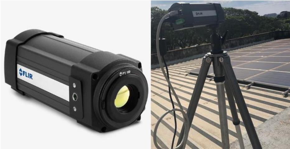
**Figura 3.19** Câmera FLIR A325 para avaliação da variabilidade da temperatura na superfície dos módulos
