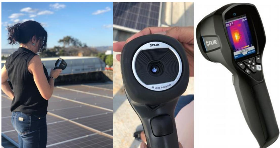
**Figura 3.18** Realização das medições de temperatura na superfície dos módulos fotovoltaicos ( a esquerda) e Termovisor FLIR I3 (imagem central e a direita)
