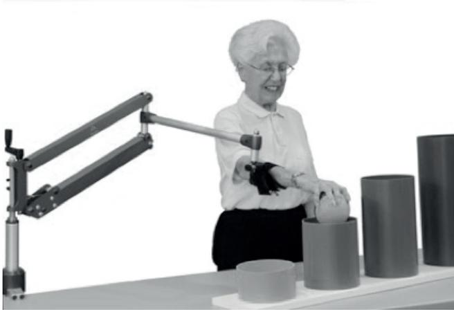
**Figura 2.3. Dispositivo 3, acoplado em uma mesa e desenvolvido para auxiliar o usuário na realização de uma atividade motora planejada para treinar movimentos que serão utilizados em contextos reais.**
