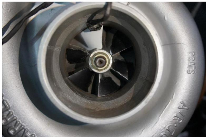
Figura 3.13 – Detalhe do sensor de rotação e compressor pintado (Elaboração própria).
