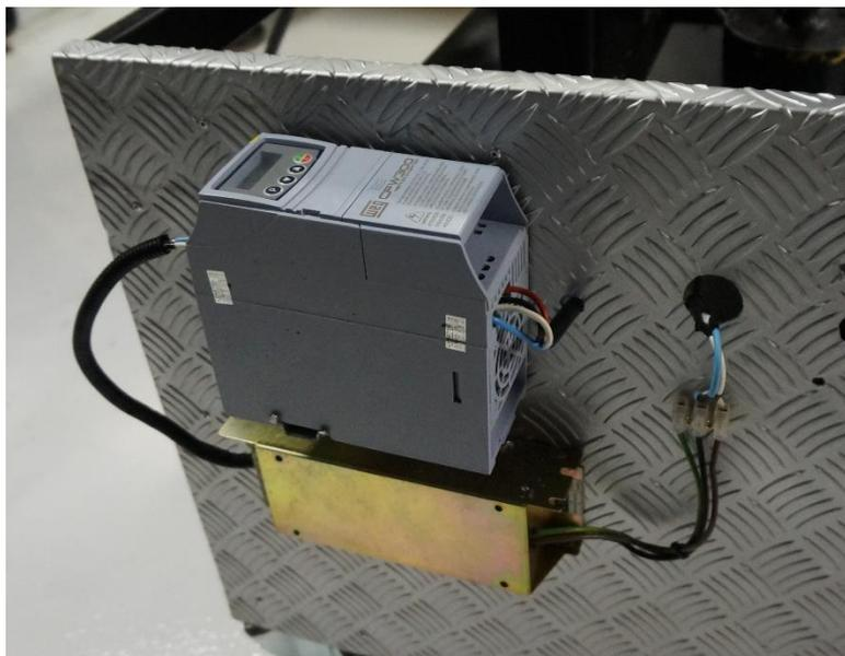
Figura 2.25 – Inversor de frequência e filtro de harmônicos (Elaboração própria).
