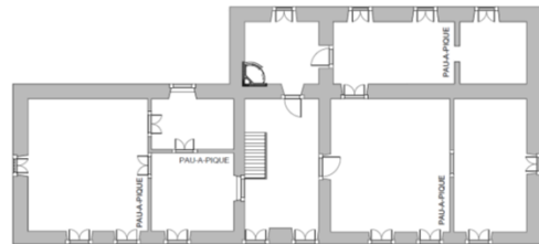
Planta do pavimento Superior
