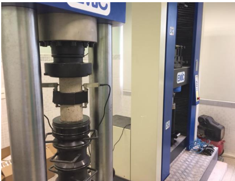
Figura 3. 21 - Ensaio de módulo de elasticidade à compressão
