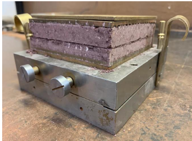
Figura 3. 15 - CP de solo saprolítico após o cisalhamento
