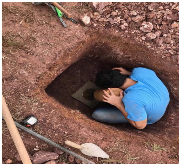
Figura 3. 8 - Ensaio de frasco de areia realizado no fundo da vala de coleta do solo saprolítico
