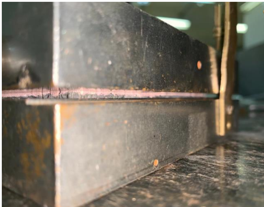
Figura 3. 28 - Detalhe do ajuste fino do plano de cisalhamento possibilitado pelo parafuso especial
