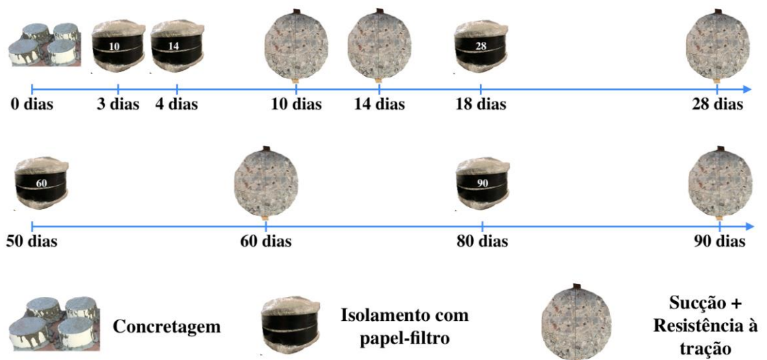
Figura 3. 20 - Cronograma dos ensaios de sucção e resistência à tração do concreto
