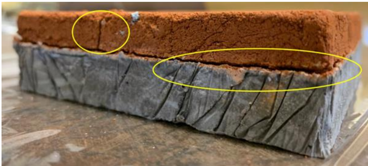
Figura 4. 52 - Perda de contato entre solo e concreto e fissuras no solo (conjunto de 90 dias de interação)
