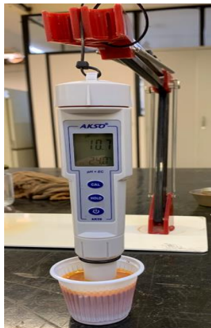
Figura 3. 9 - pHmêtro imerso em solução de solo laterítico e água destilada
