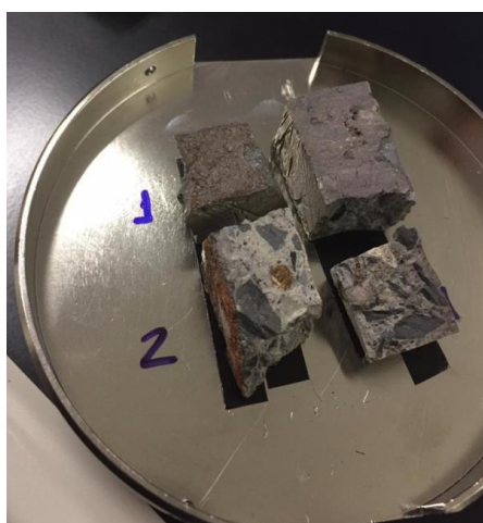
Figura 3. 29 - Amostras metalizadas utilizadas no MEV
