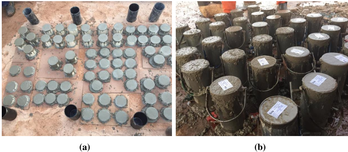
Figura 3. 18 - (a) Moldes de PVC fabricados (b) Moldes de aço padrão
