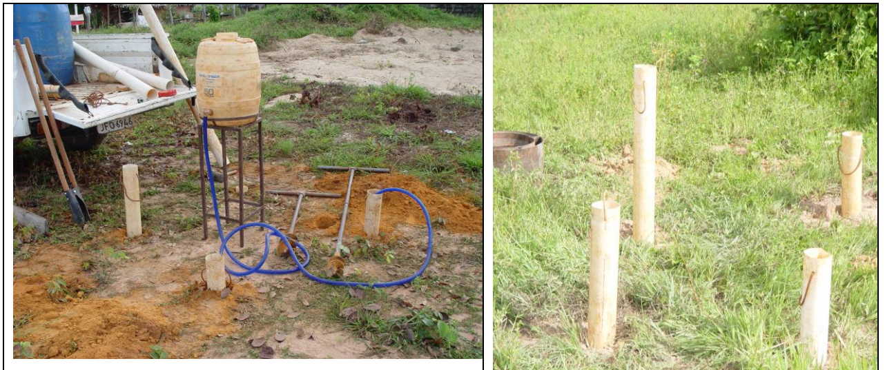
Foto 2 – Ensaios de infiltração – Etapa pré campanhas de amostragem.
