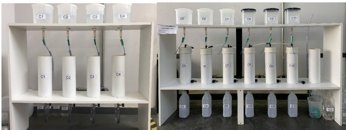
Figura 3-4 – Equipamento construído para o realização dos ensaios de coluna de lixiviação
