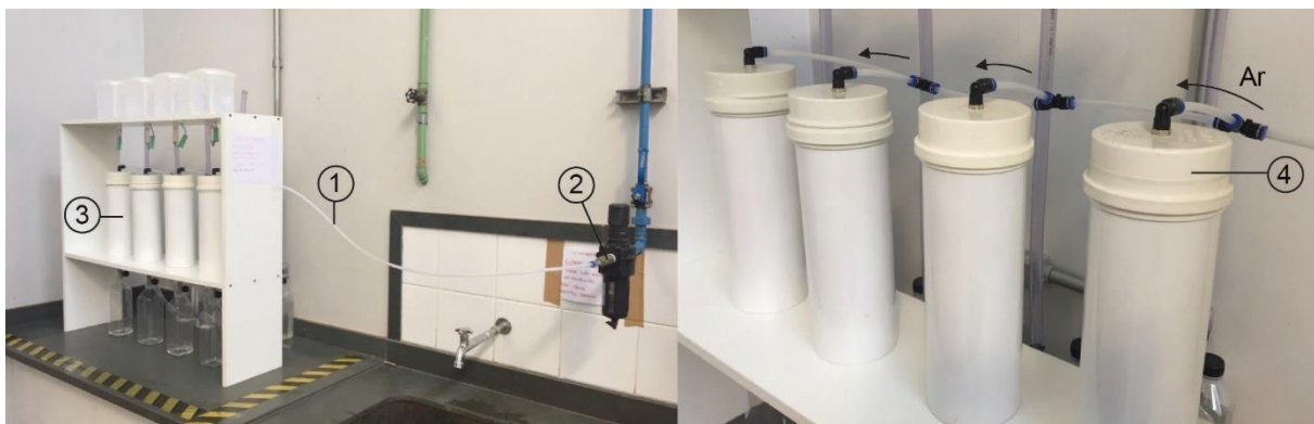
Figura 3-9 – Montagem do ensaio para o ciclo seco (o sentido do fluxo de ar está indicado na figura)
