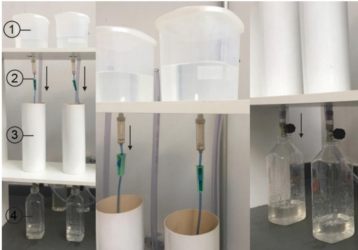
Figura 3-8 – Montagem do ensaio para o ciclo úmido (o sentido do fluxo está indicado na figura)
