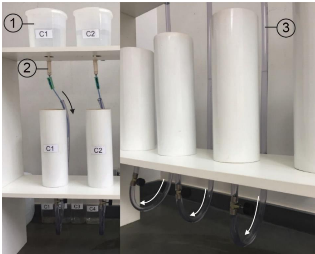
Figura 3-7 – Montagem do ensaio para a lavagem inicial (o sentido do fluxo está indicado na figura)
