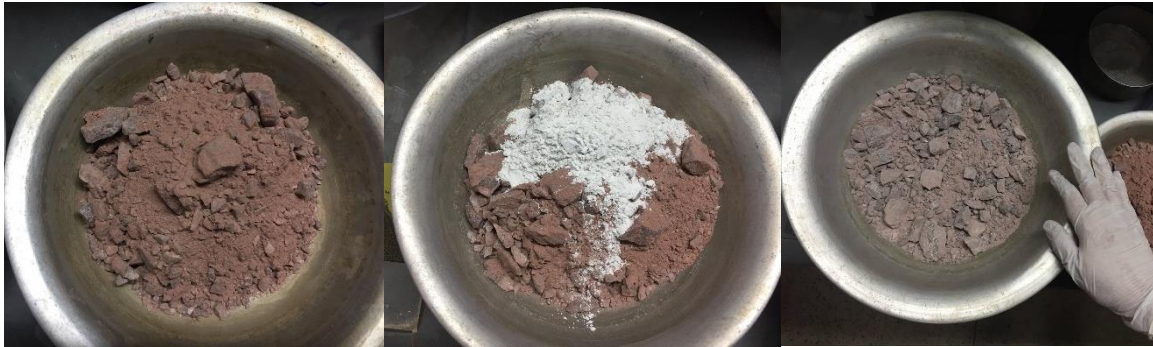
Figura 3-3 – Preparação da Cobertura 1 utilizada nos ensaios de coluna de lixiviação
