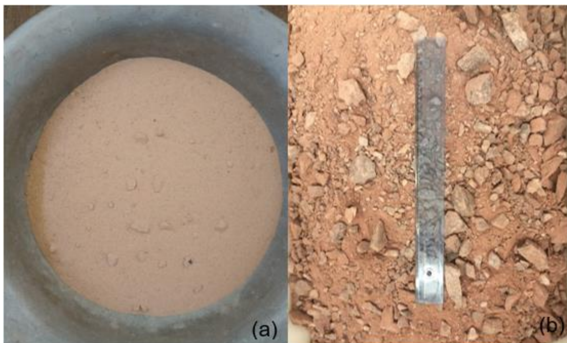
Figura 3-1 – Amostras de rejeito (a) e estéril (b) utilizadas nos ensaios de coluna de lixiviação
