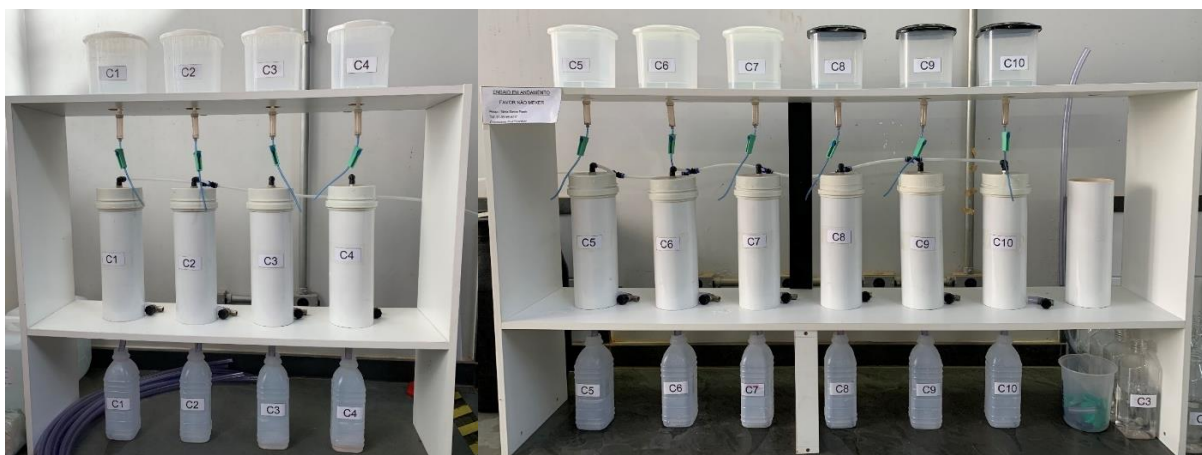
Figura 3-14 – Colunas de Lixiviação – Ciclo seco – Colunas C1 a C10
