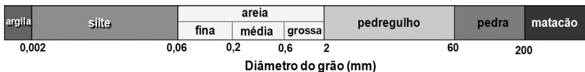
Figura 3-2 – Sistema de Classificação de Solos segundo NBR 7.181 (ABNT, 2016)
