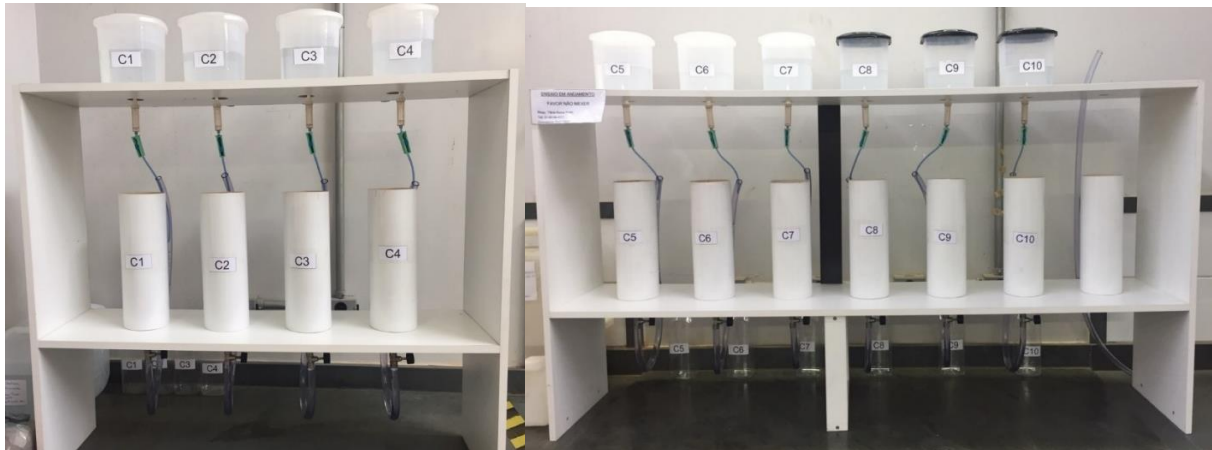
Figura 3-11 – Colunas de Lixiviação – Lavagem inicial – Colunas C1 a C10
