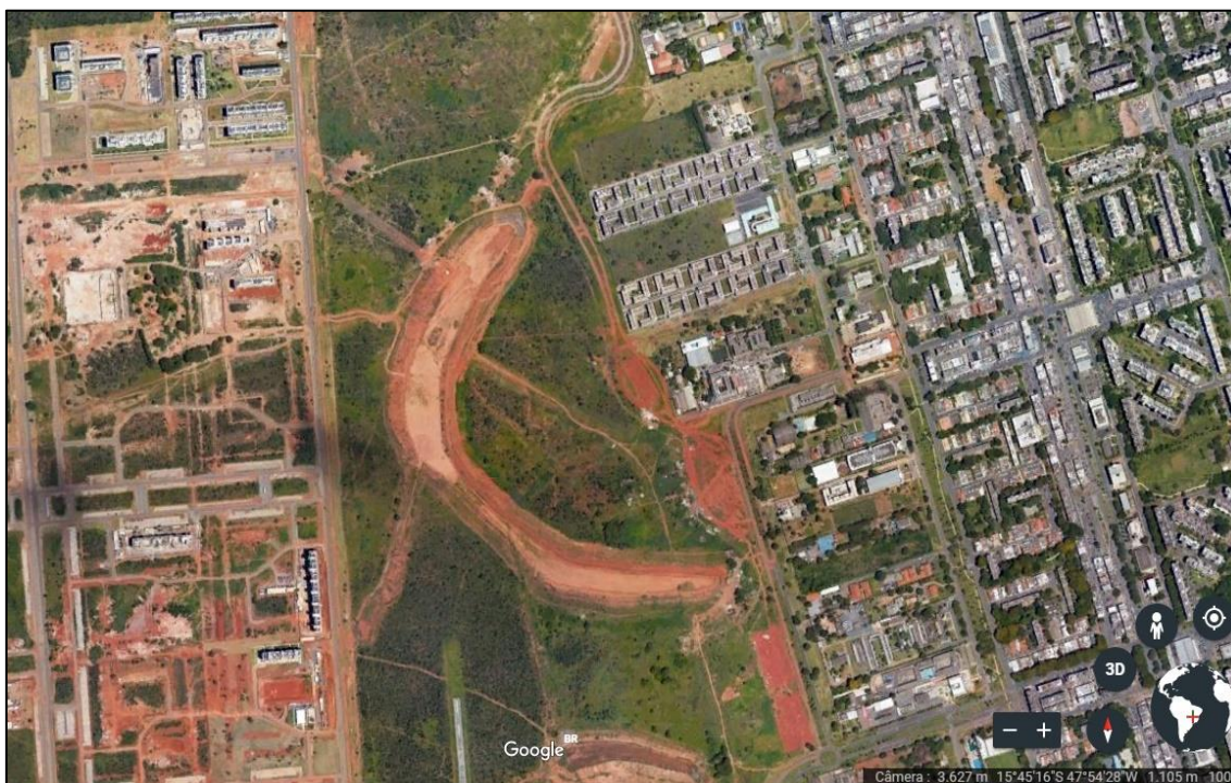
Figura 3.23: Exemplo de lagoa de detenção no Parque Burle Marx, Setor Noroeste, Brasília-DF. Fonte: Google Earth, 15/06/2018 editada.
