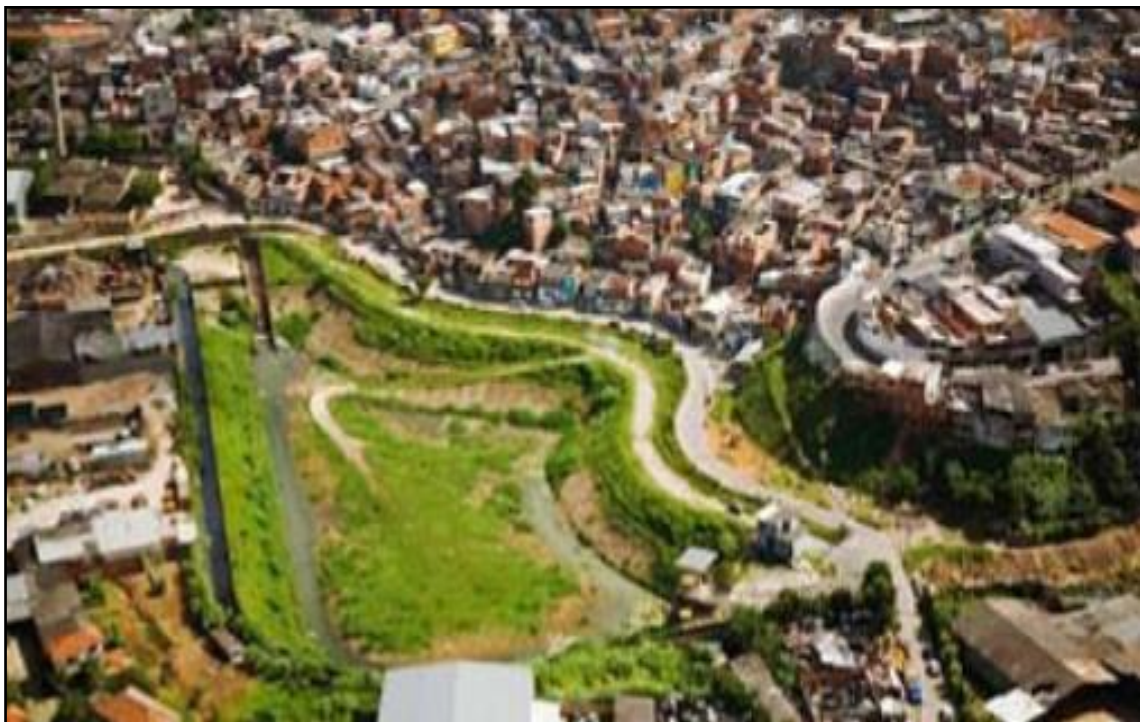
Figura 3.22: Exemplo de lagoa de detenção ao lado de área densamente ocupada em Taboão da Serra/SP, Brasil. Disponível em: http://tecetera.blogspot.com/2011/01/acao-contra-enchentes.html
