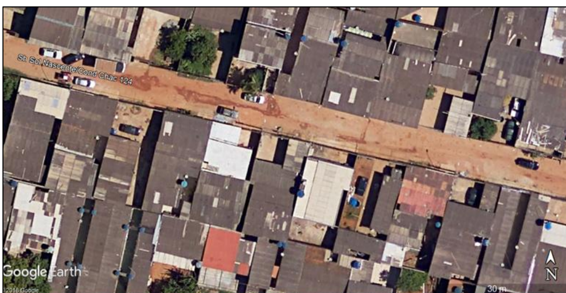
Figura 5.13: Rua do Trecho 3 da ARIS Sol Nascente com dimensões de logradouro inferiores às normas do DF, com características de ocupação dos lotes que tendem a 100% de impermeabilização. Fonte: Imagem do Google Earth.
