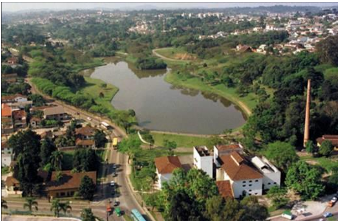
Figura 3.20: Exemplo de lagoa de retenção no Parque São Lourenço, Curitiba/PR. Disponível em: http://www.curitiba.pr.gov.br/conteudo/parques-e-bosques-parque-sao-lourenco/317
