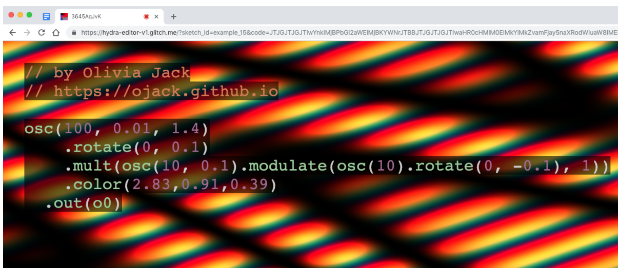
Imagem 58. Interface do sistema Hydra, funcionando via internet.
