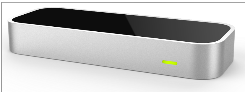
Imagem 71. O sensor para percepção de mãos Leap Motion (7 x 3 x 2 cm).
