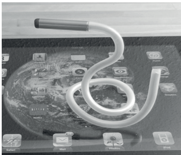
Figura 2.2. Dispositivo sobre a tela de um tablete que, quando fixado à mão do usuário, facilita o acionamento da tela sensível ao toque.
