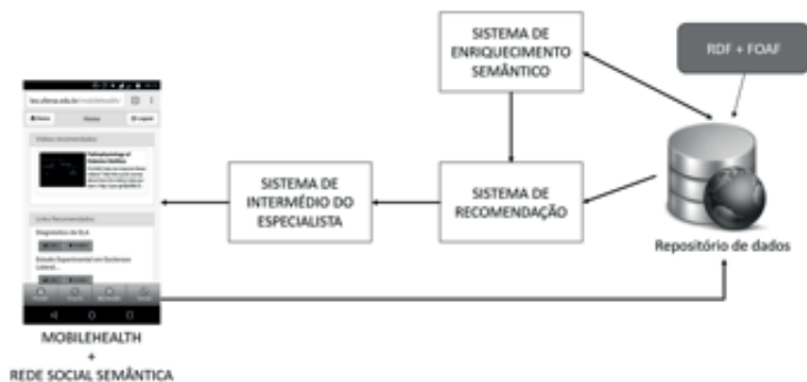
Figura 3.2. Arquitetura de funcionamento dos sistemas apresentados.
