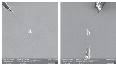
Figura 7.7 Imagens obtidas com o MEV da seção transversal do centro do ponto solda da amostra embutida (Aumento de 2kx). (a) Região da Solda A (b) Região da Solda B.
