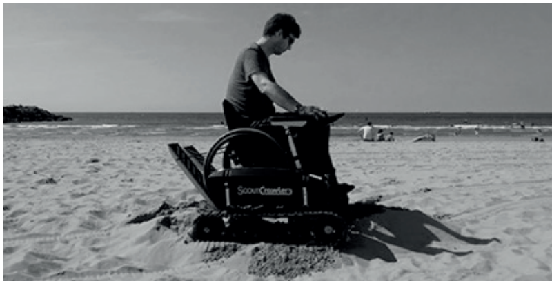
Figura 2.5. Pessoa com limitação da locomoção e restrição da participação em atividades de praia utilizando dois produtos assistivos (uma cadeira de rodas com um dispositivo acessório) que permitiu o deslocamento em terreno arenoso.
