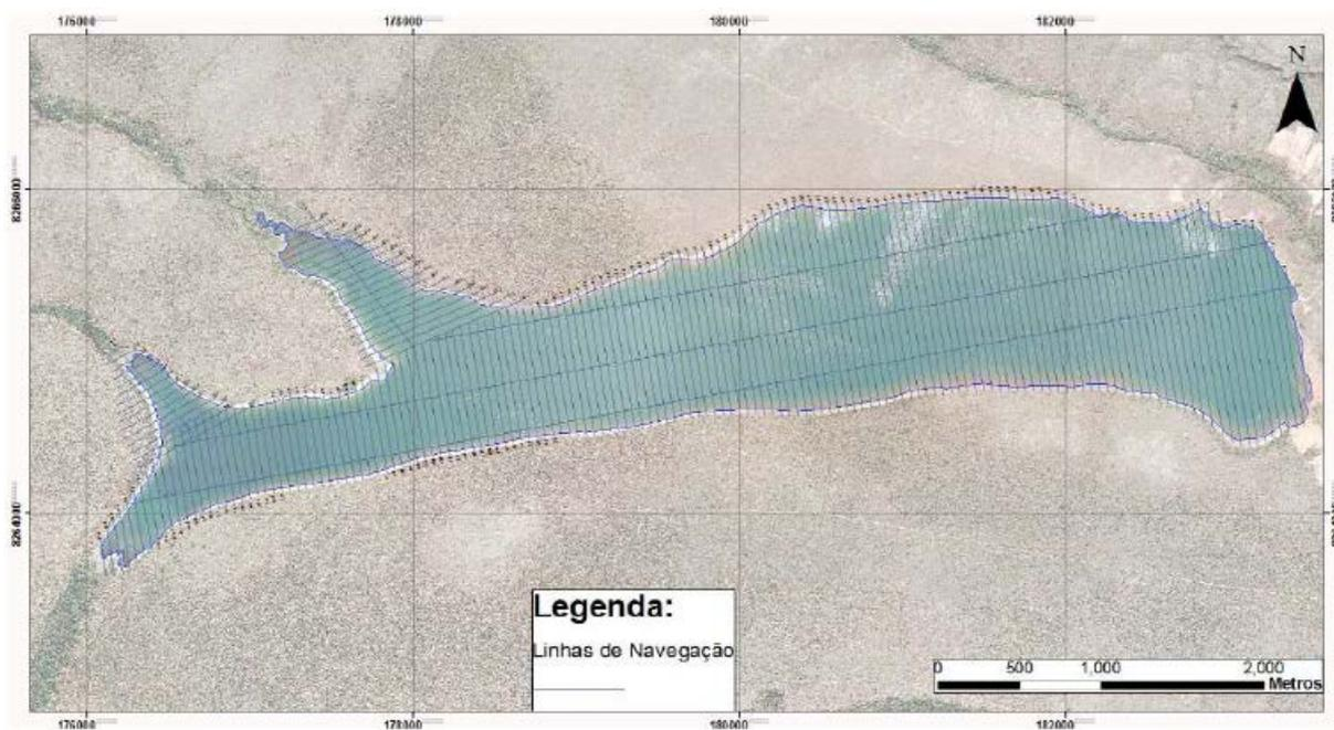
**Figura 24 – Linhas de navegação para o levantamento batimétrico do reservatório de Santa Maria.**
