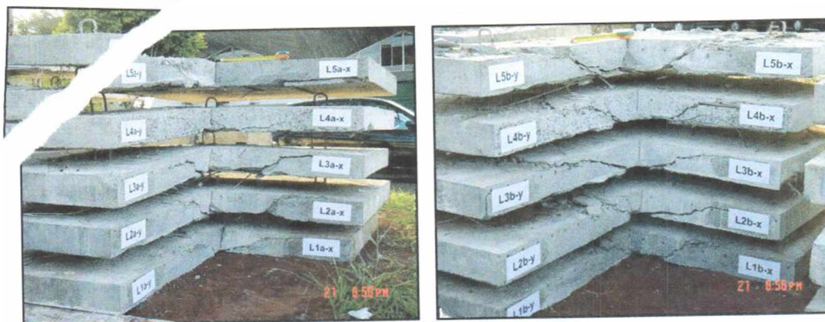
Figura 4.38 – Superfícies de ruptura das lajes “a” e “b”
