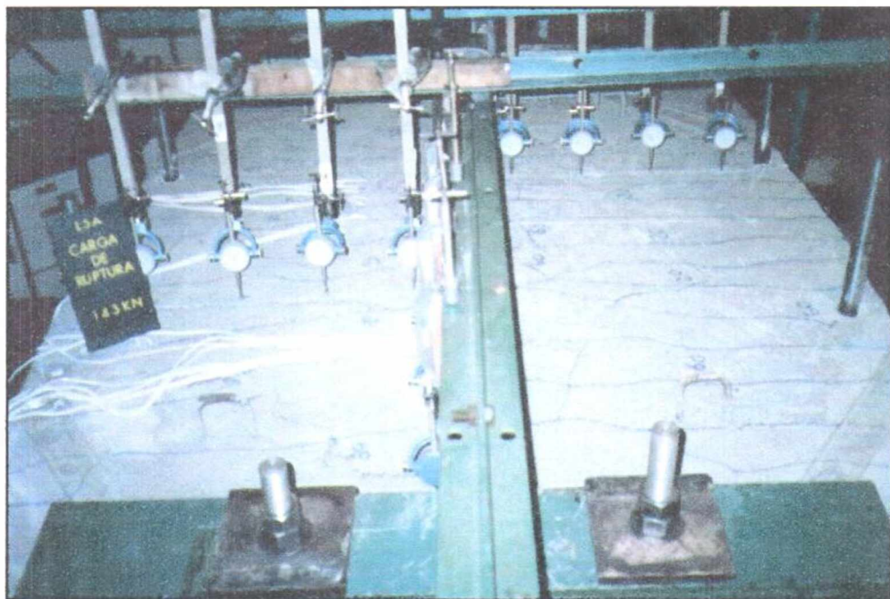
Figura 4.18 – Mapa de fissuração da laje L5a
