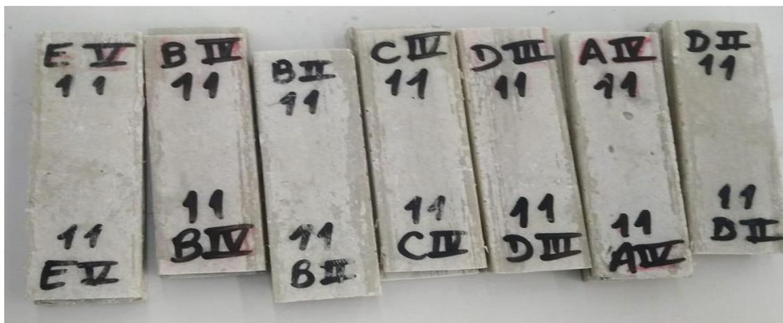
**FIGURA 12 - Pedra sintética de Referência com 100% de carga como calcário**
