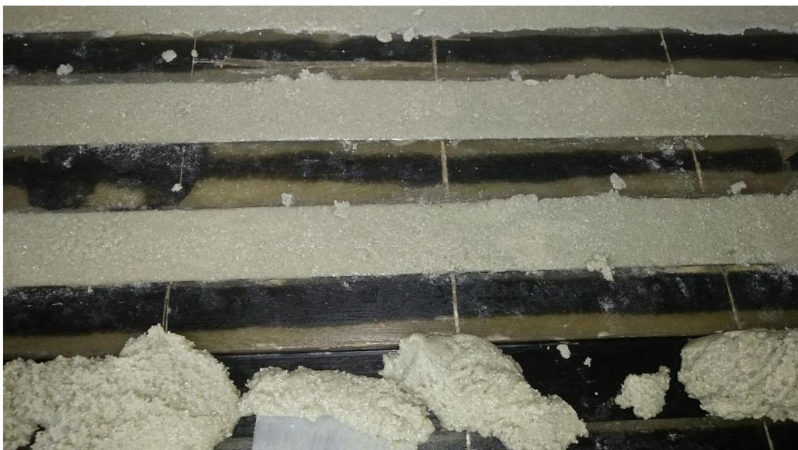
**FIGURA 6 - Molde sendo preenchido com compósito a base de perlita**
