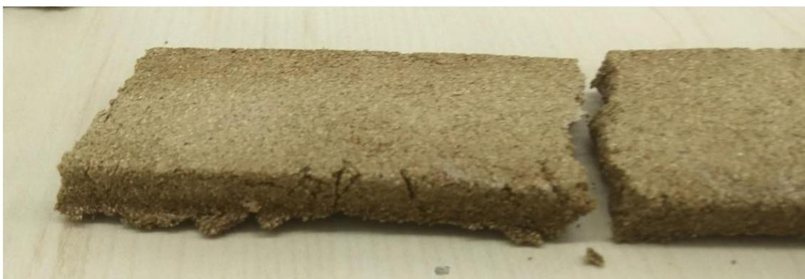
**FIGURA 14 - Peça produzida com 100% de vermiculita**
