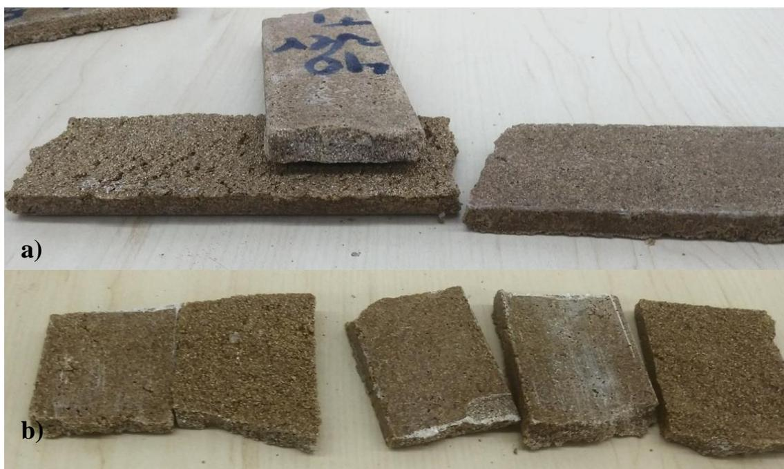
**FIGURA 13 – Corpos de prova a) com 40% de vermiculita e b) 60% de vermiculita**
