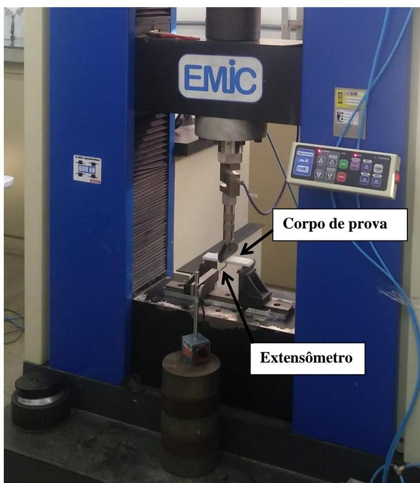
**FIGURA 11 – Máquina de ensaios universal**
