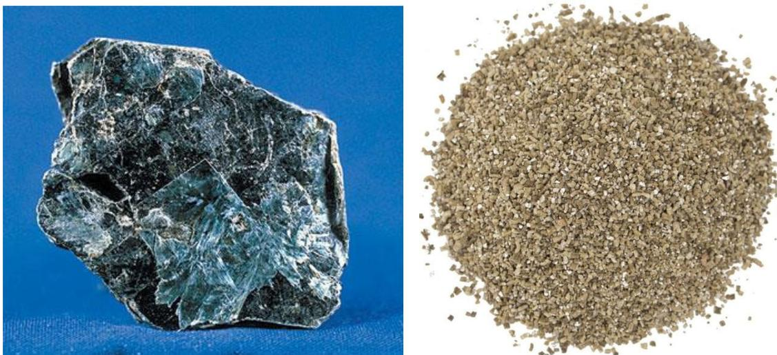
**FIGURA 3 – Vermiculita, a esquerda na forma mineral e a direita na forma expandida**
