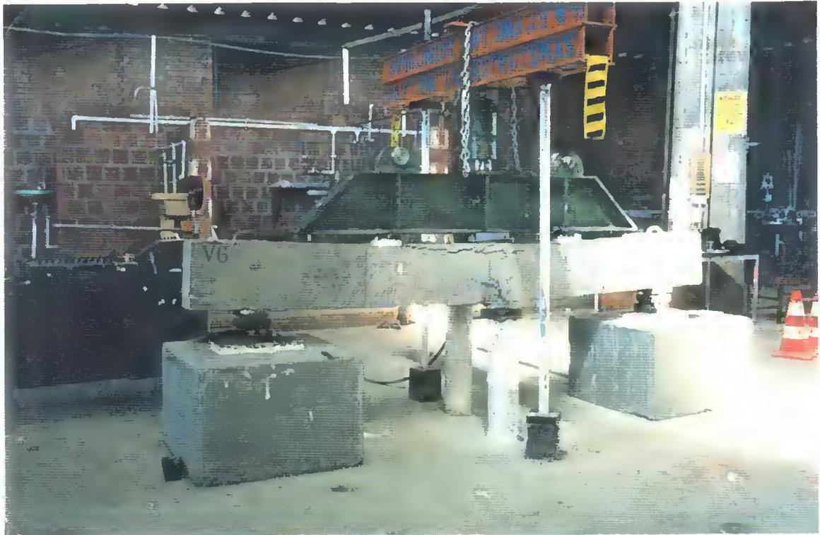
**Figura 5.7 - Esquema geral da ruptura da viga V6**
