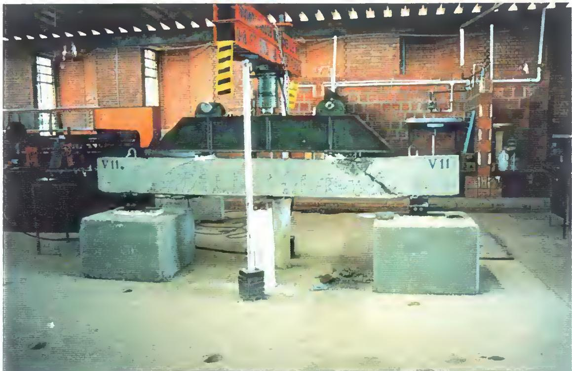
Figura 5.14 - Esquema geral da ruptura da viga V11
