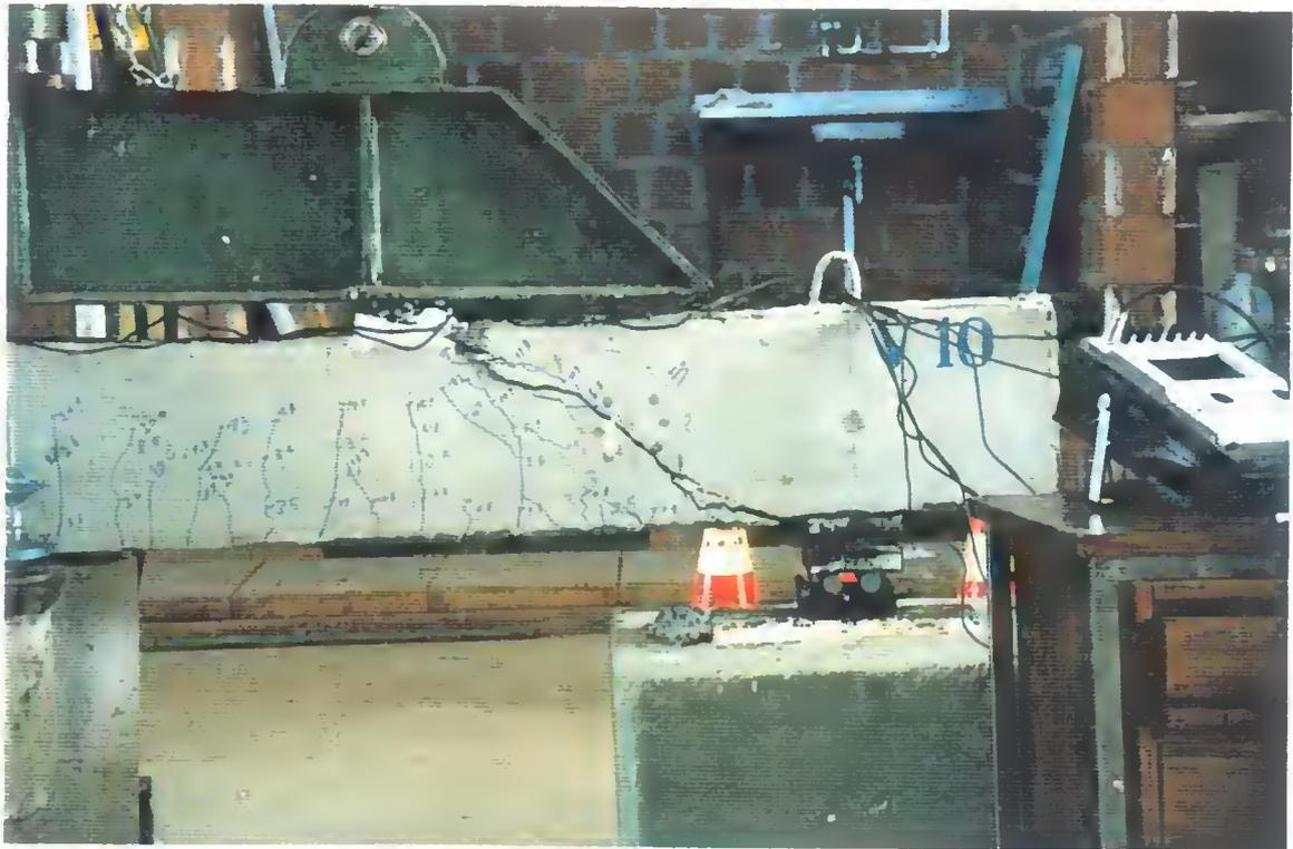
Figura 5.13 - Detalhe da ruptura da viga V10
