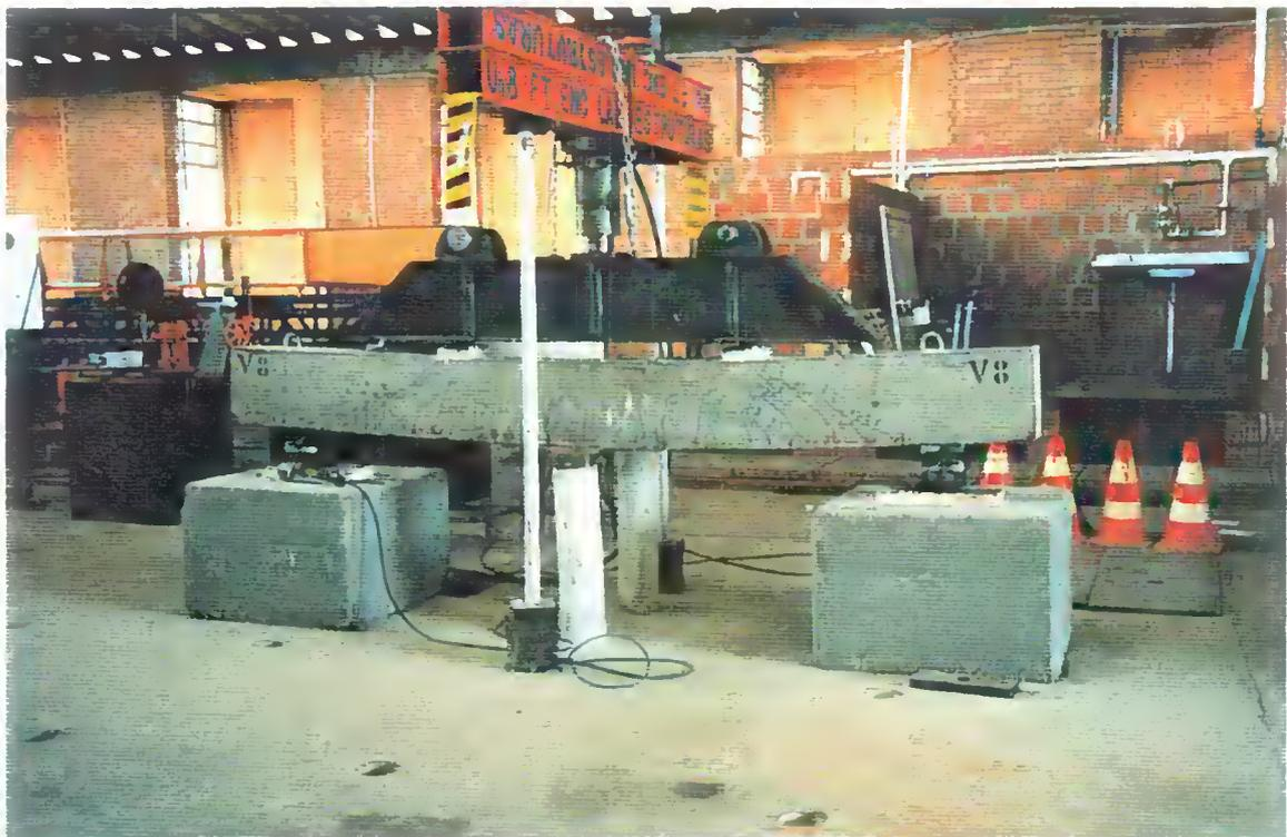
Figura 5.10 - Esquema geral da ruptura da viga V8
