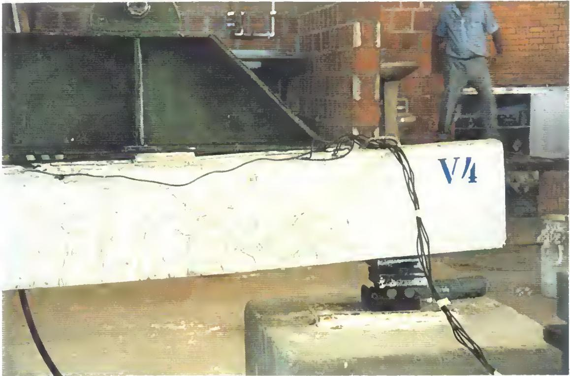
**Figura 5.5** - Detalhe da ruptura da viga V4
