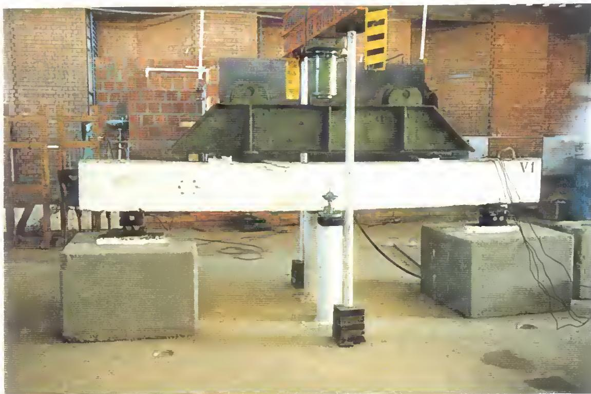
Figura 5.1 - Esquema geral da ruptura da viga V1
