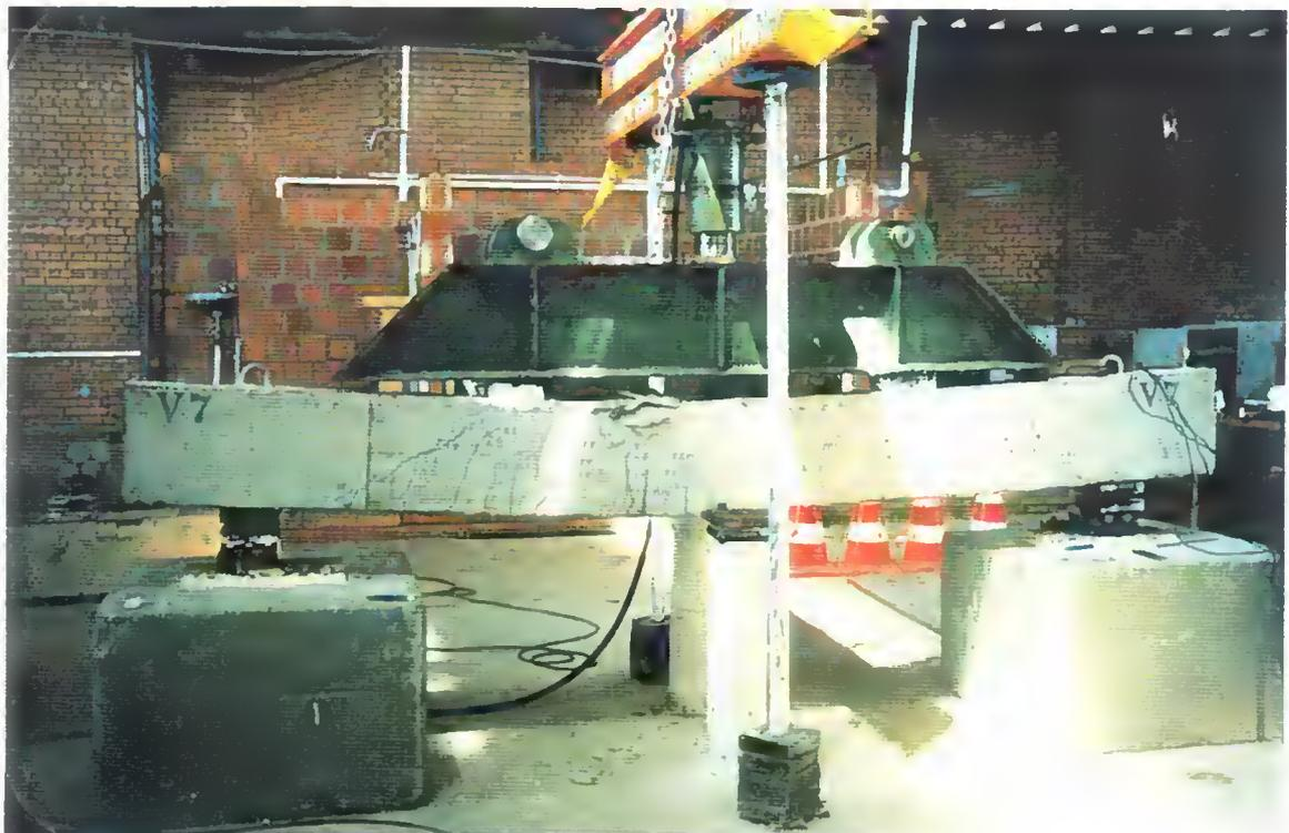
**Figura 5.8 - Esquema geral da ruptura da viga V7**
