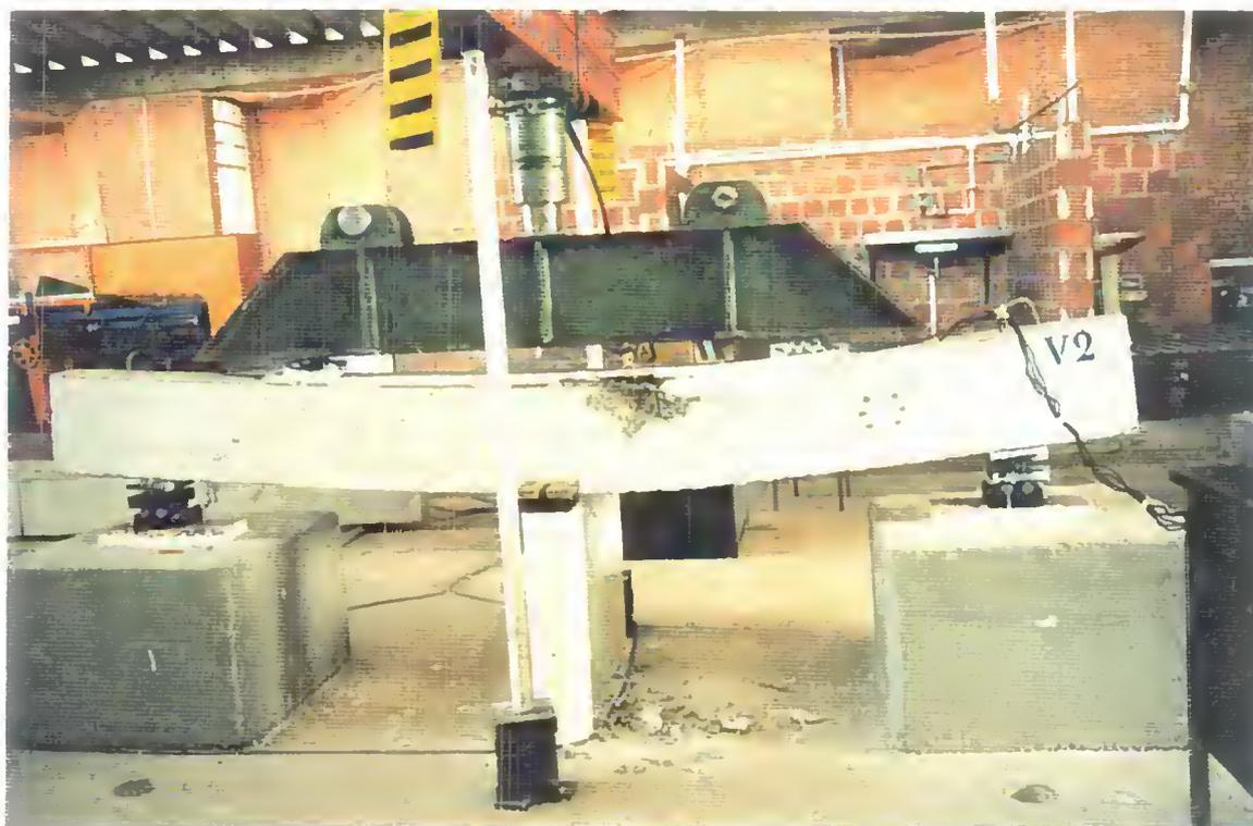
Figura 5.2 - Esquema geral da ruptura da viga V2
