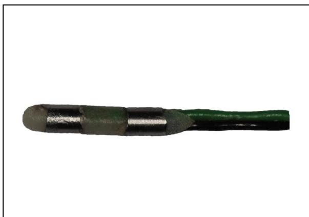
Figura 5. Fotografia da sonda de eletroestimulação produzida e adaptada às dimensões do canal anal e vaginal de ratas Wistar.
