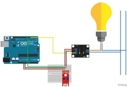
Figura 13. Circuito do Sensor Luminoso
