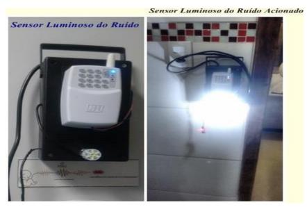
Figura 15. Protótipo do Sensor Luminoso instalado
