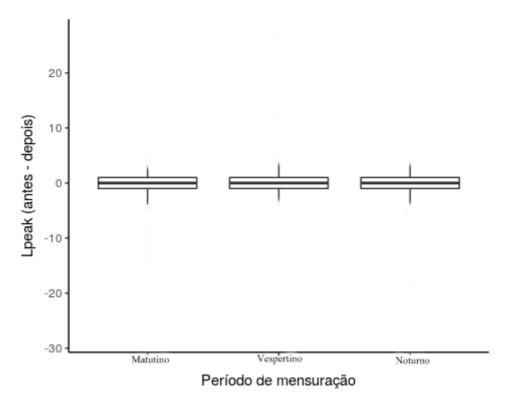
**Figura 17.** Diagrama de caixas (box plot) do Lpeak <sub>(antes-depois)</sub> nos três turnos do período de mensuração.
