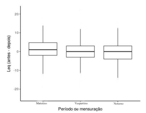
**Figura 16.** Diagrama de caixas (box plot) do Leq <sub>(antes-depois)</sub> nos três turnos do período de mensuração.
