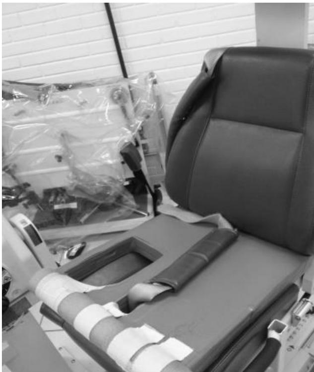
**Figura 4.** Assento utilizado para captação de sinal eletromiográfico do músculo Bíceps Femoral.
