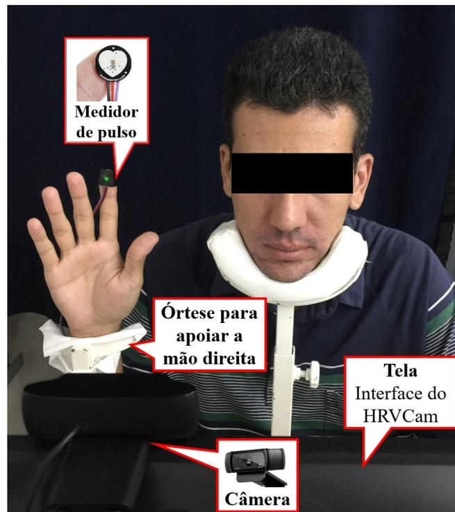
**Figura 3.39.** Visão frontal do posicionamento do participante e dos sensores na bancada de testes.
