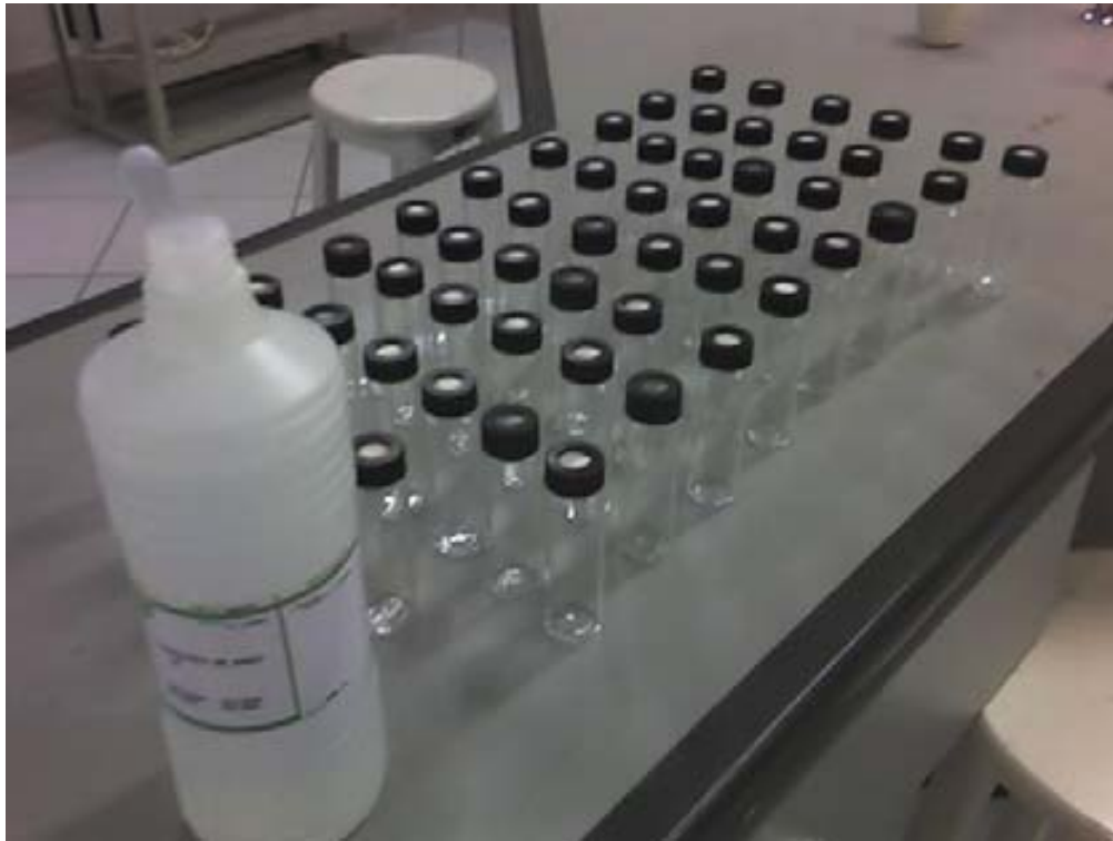
Foto 1 – Recipientes de 20 mL contendo Tiosulfato de Sódio para coleta de amostras de água para análise de THMs. (foto: Vonivaldo G. Leão)
