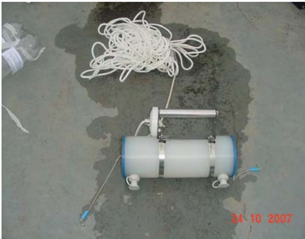
Foto 2 – Garrafa de Van Dorn de 2 litros de capacidade para coleta de água nas estações de tratamento. (foto: Vonivaldo G. Leão)
