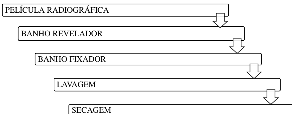
Figura 7: Fluxograma das etapas da revelação Fonte: Adaptado de REIS (2004)
