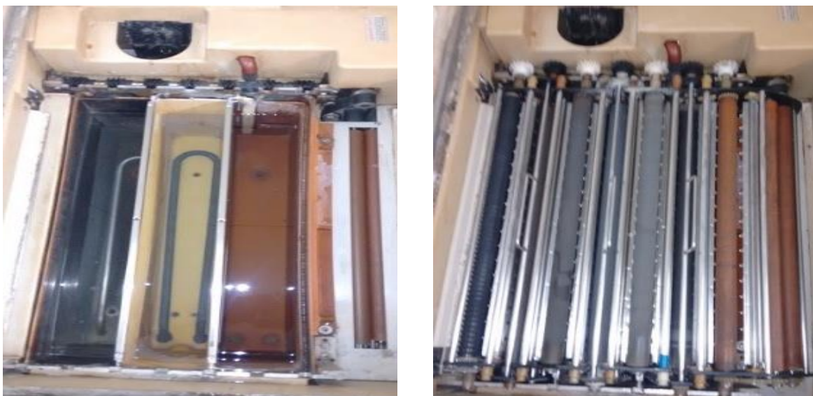
Figura 8: Tanque de revelação sem e com os racks Fonte: Autor da pesquisa
