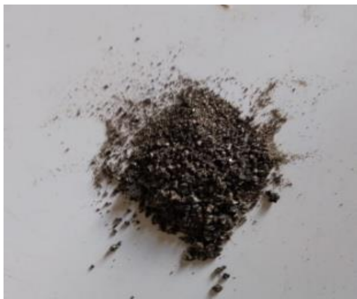
Figura 12: Depósito de prata obtido com impureza Fonte: Autor da pesquisa
