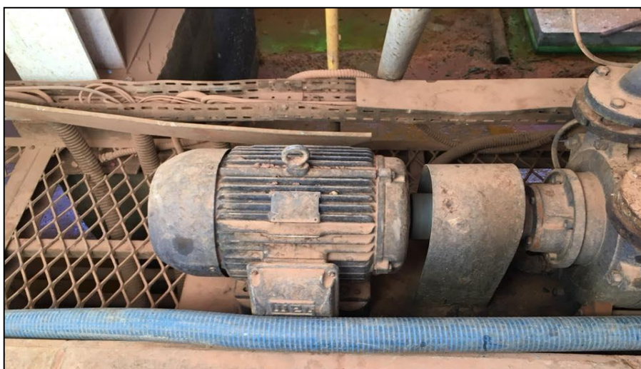
Figura 3.15: Motor elétrico responsável pelo vácuo inicial e final da imunização do eucalipto.
