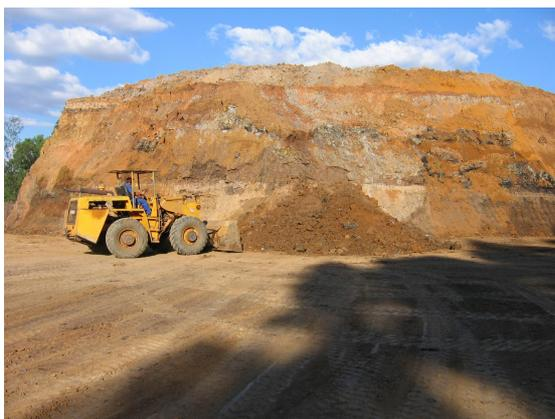
Figura 3.3 – Sazonamento de argila para a produção de blocos cerâmicos em uma indústria cerâmica de Campo Limpo/GO
