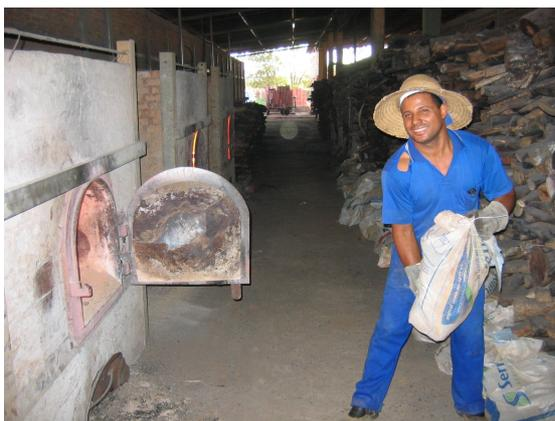
Figura 5.25 – Mão-de-obra (operador do forno) empregada na queima dos blocos a partir de briquetes
