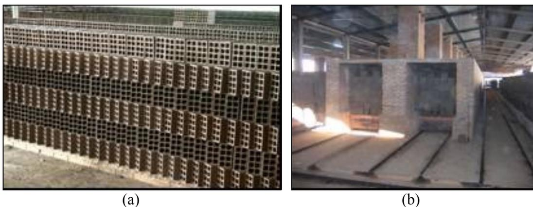
Figura 3.6 – Métodos de secagem de blocos cerâmicos em uma indústria cerâmica de Campo Limpo/GO. a) secagem natural e b) secagem artificial.
