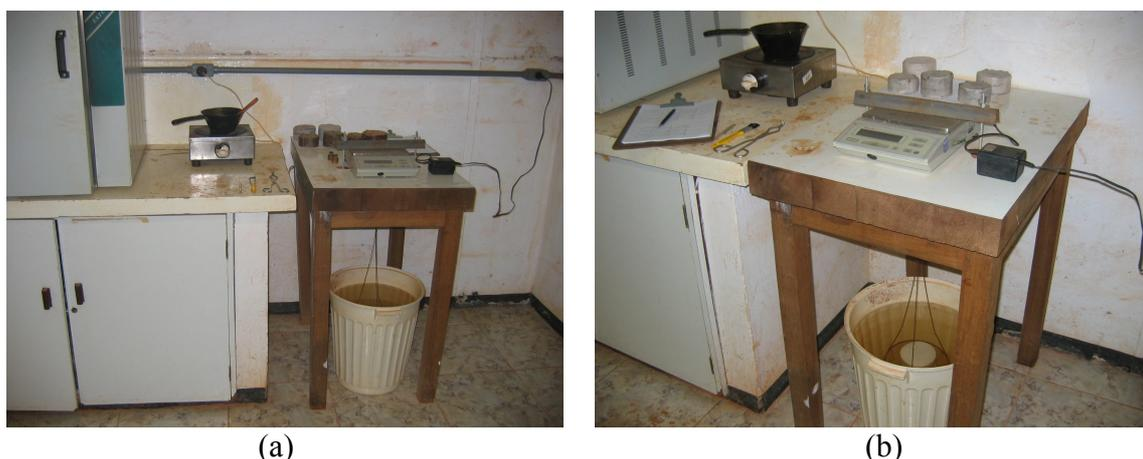
Figura 4.6 – Equipamentos utilizados no ensaio de massa específica aparente dos combustíveis analisados. a) determinação da massa antes do briquete ser parafinado; b) determinação da massa do briquete parafinado, imerso em água.
