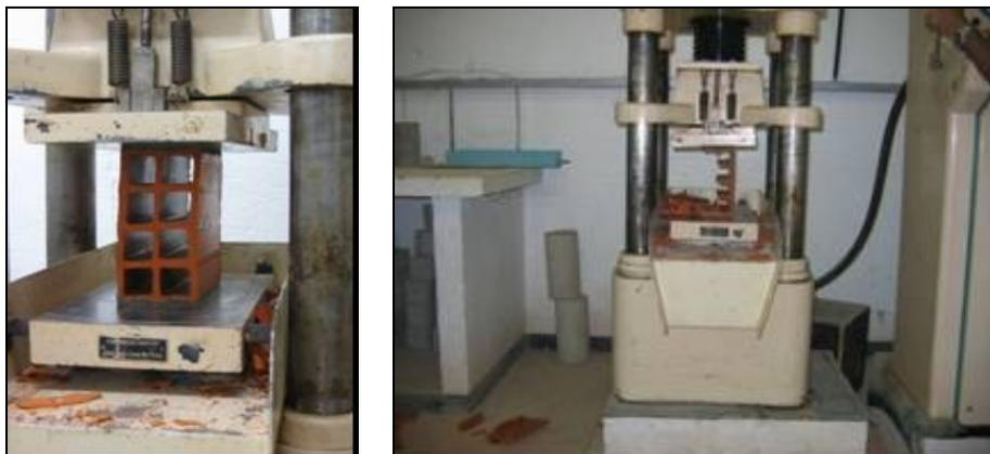
Figura 4.12 – Ensaio de resistência à compressão e vista do momento de ruptura de blocos.
