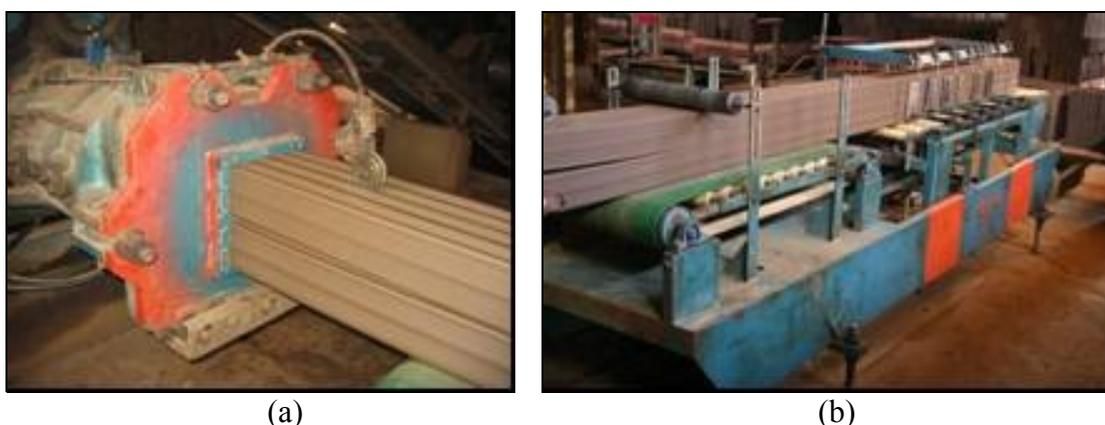
Figura 3.5 – Produção de blocos cerâmicos em uma indústria cerâmica de Campo Limpo/GO. a) boquilha de moldagem; b) mesa de corte.
