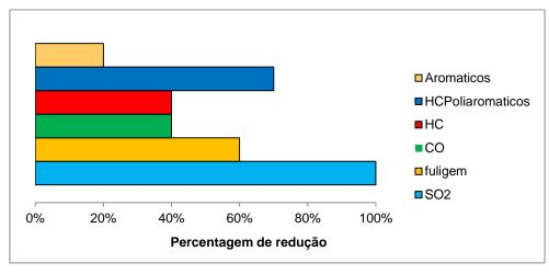
Figura 11 - Redução de poluentes devido ao uso de biodiesel.
