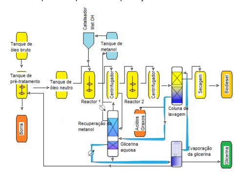
Figura 66 - Esquema do processo de produção de biodiesel na BINATURAL.
