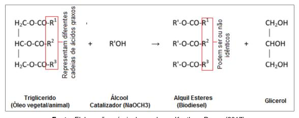
Figura 4- Reação de transesterificação para produzir biodiesel.
