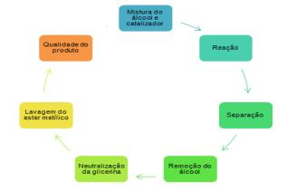
Figura 3- Processo industrial da reação da transesterificação.
