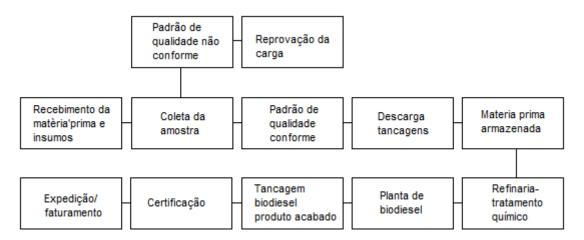
Figura 65 – Fluxograma geral da produção de biodiesel na BINATURAL.
