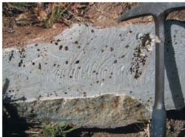
Figura 3.11 – Carbonato esteatito com boxwork de carbonato e magnetita;
