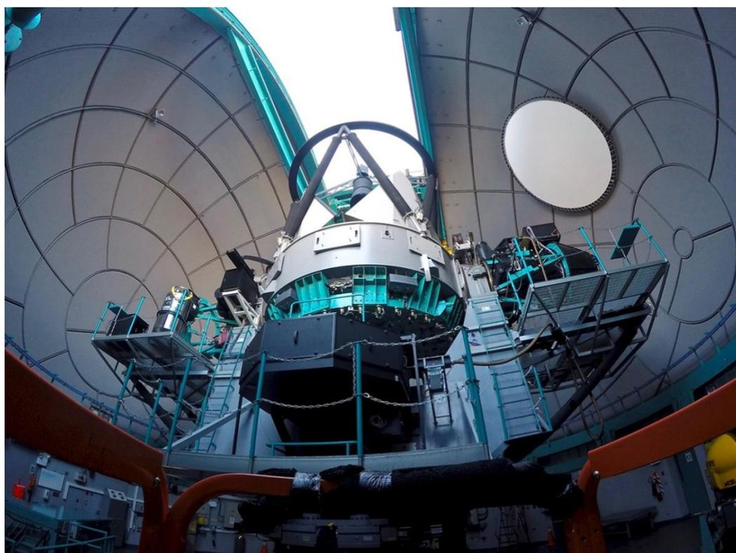
**Figura 6.** O telescópio SOAR de 4m em Cerro Pachón, Chile, com sua cúpula fechada.
