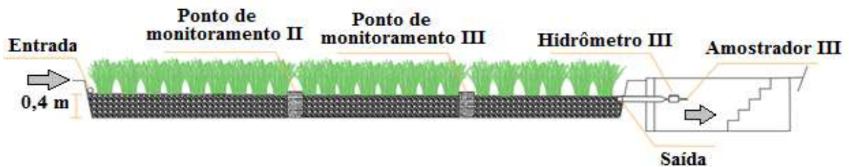
Figura 4.13 – Perfil longitudinal (em seção média) da célula de tratamento de esgoto WC-FSSH.
