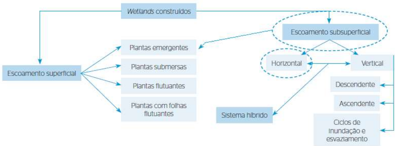
Figura 3.1 – Classificação das WCs segundo o fluxo hidrodinâmico e tipo de vegetação. Fonte: Vymazal e Kröpfelová (2008).
