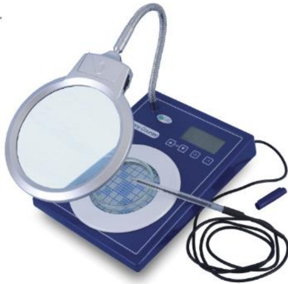
Figura 1: Aparelho Contador de colônias com placa de Petri na bacia de sustentação
