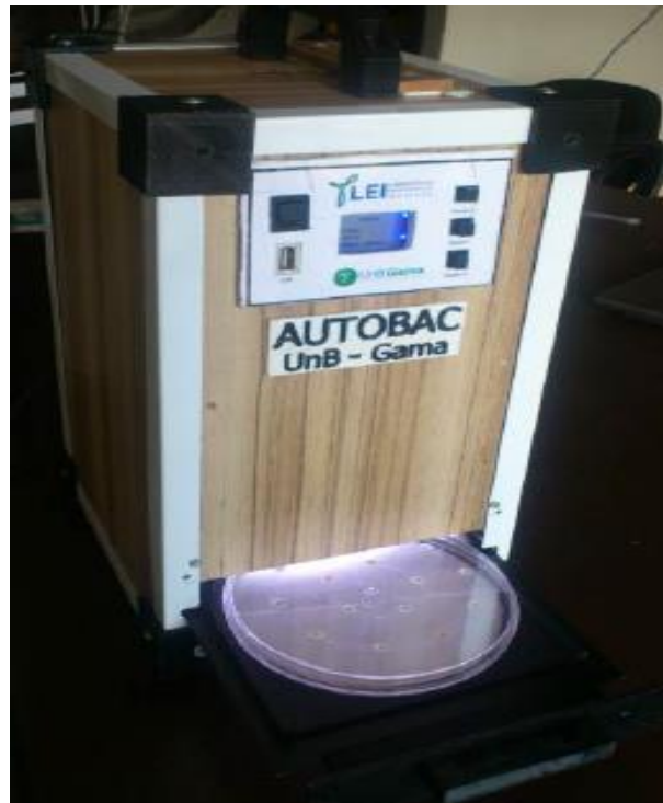
Figura 11: Vista externa do protótipo da AUTOBAC, com placa de Petri posicionada sobre a gaveta de sustentação (ARVELOS, 2015).
