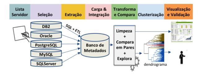
Figura 4.1: Visão Geral da Solução.
