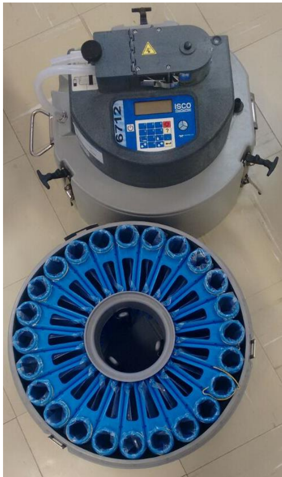
Figura 4.14 – Amostrador automático ISCO 6712 aberto.
