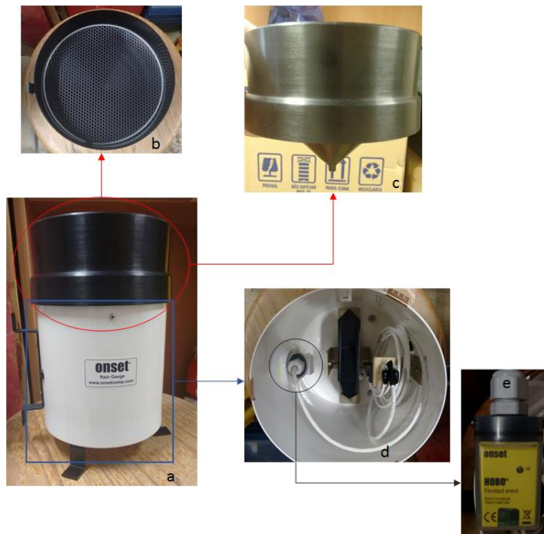
Figura 4.10 – (a) Pluviógrafo; (b) Vista superior do pluviógrafo; (c) Parte superior do pluviógrafo (funil); (d) Parte interna do pluviógrafo; e (d) Data logger .
