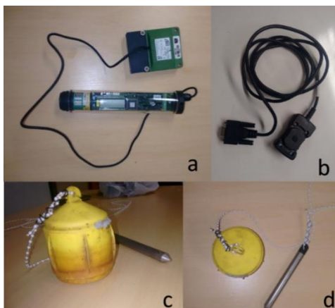
Figura 4.12 – Linígrafo de boia da marca OTT® , modelo Thallimedes . (a) Logger ; (b) Leitor infravermelho ; (c) e (d) Boia e contrapeso .
