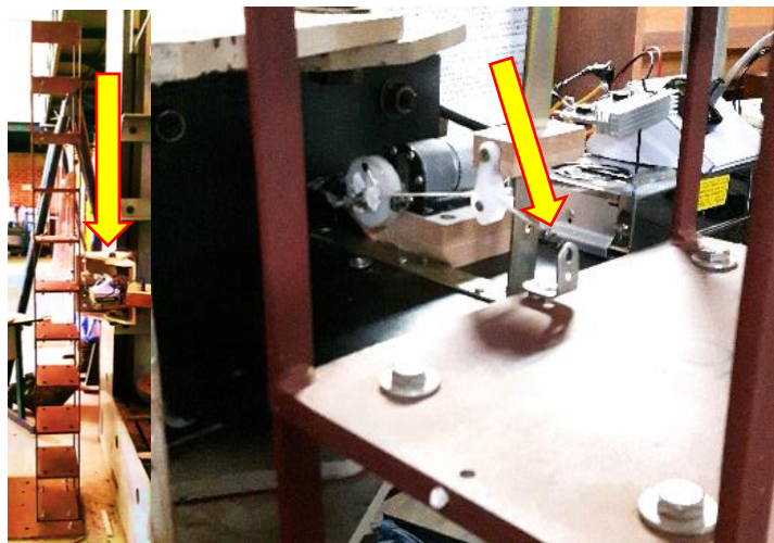
Figura 4.18 – Excitador conectado à estrutura.
