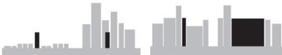
Figura 2.1 – Ilustração dos conceitos de “altura relativa” (a) e “Proporção” (b). (Fonte: CTBUH, 2017).
