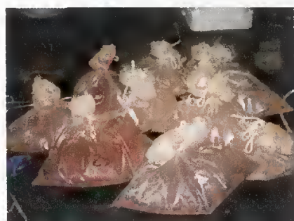
(a) Amostras previamente preparadas com umidade pré-determinadas e estabilizadas 24 horas antes da compactação.
