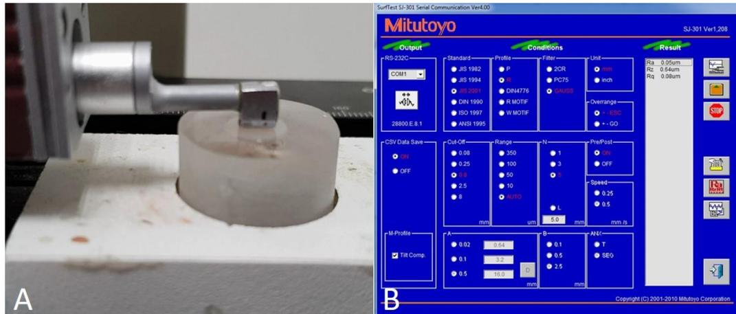
Figura 3 – Análise de rugosidade dos espécimes. A, leitura no rugosímetro. B, transcrição dos dados no software.
