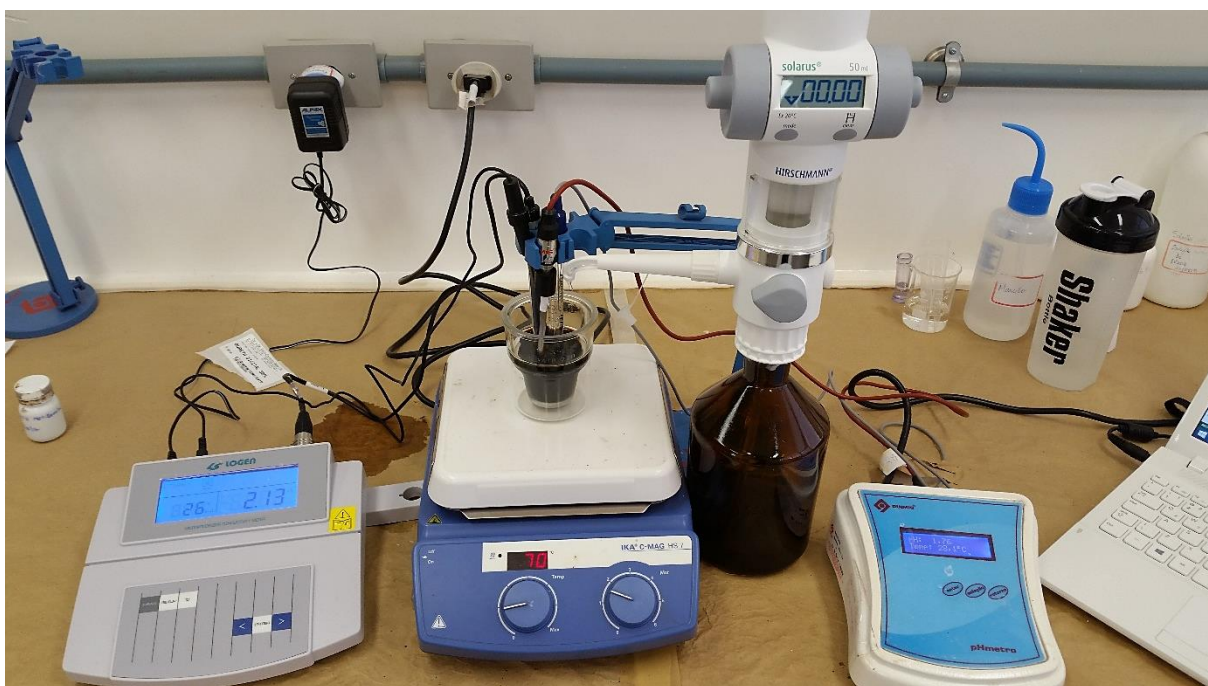
Figura 12: Esquema geral da titulação pelo Método Potenciométrico- Condutimétrico (MPC). Dentro do frasco de vidro temos: 40mL da dispersão; eletrodo de pH; eletrodo de condutividade; 2 termômetros (pH e k); bastão magnético para agitação.
