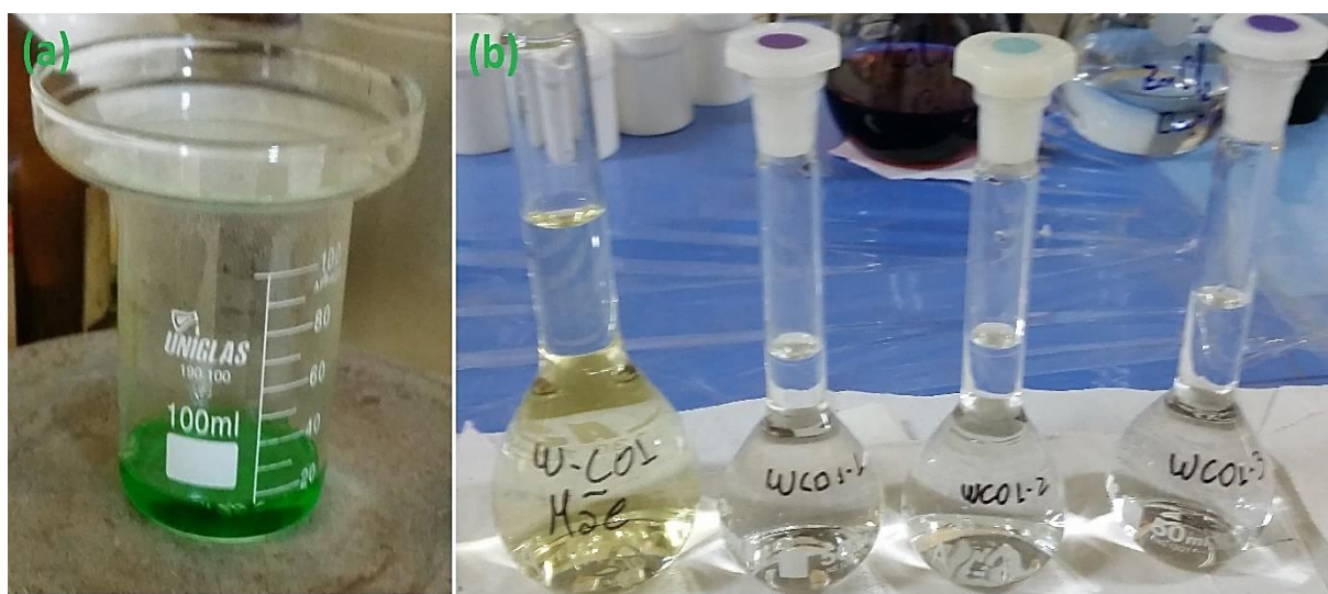
Figura 9: Etapas da dosagem química das amostras: (a) amostras do ferrofluido após a adição de HCl, (b) amostra diluída em triplicata numa razão de 1:100.000.
