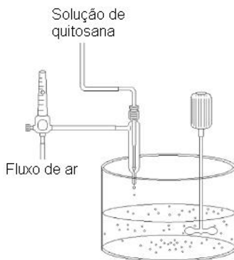
Figura 11 – Esquema do sistema de preparação de microesferas por coagulação
