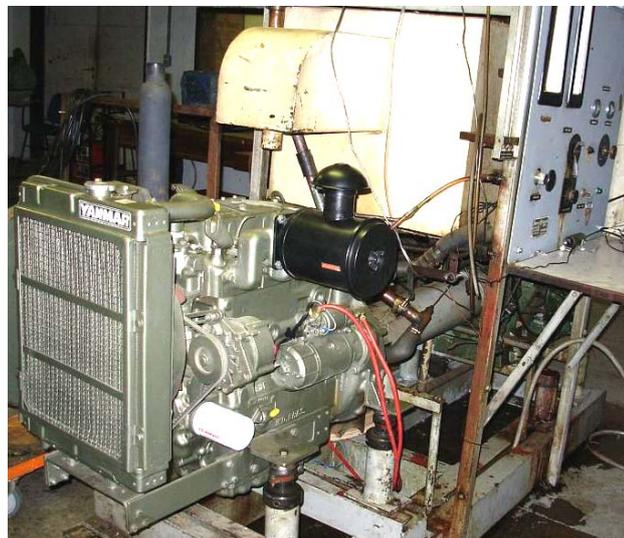
Figura 3.5 - Motor Diesel na Bancada do dinamômetro.
