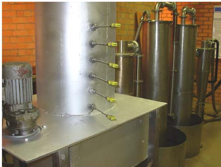
Figura 3.12 - Termopares tipo K ao longo do corpo do Reator.
