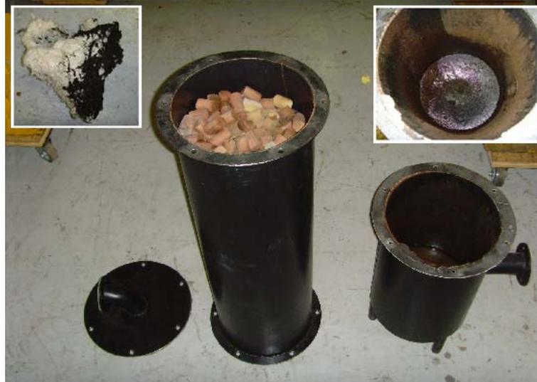
Figura 4.25 – Filtro seco após realização dos ensaios. Elemento do filtro: semente de açaí e madeira de cedrinho.
