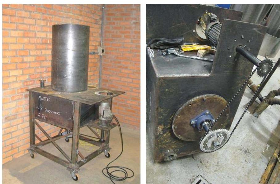
Figura 3.3 - Reator R1 e sistema de movimentação da grelha.
