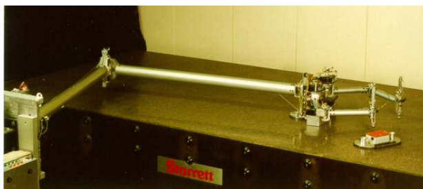
Figura 2.2: Braço robótico de dois elos de Stanford . Fonte: (SCHUBERT; HOW, 1997)
