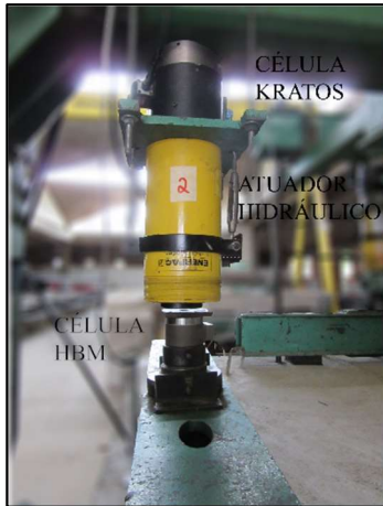
a) Detalhe da célula de carga e atuador hidráulico
