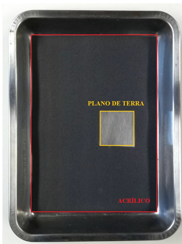
Figura 21 – Plano de terra do eletrodo de retorno. Esta figura mostra o isolante acrílico (material de cor preta), o material condutor (suporte metálico) e o corte retangular nas dimensões 6 x 6 cm que permitia a condução somente nessa região aonde o animal foi posicionado deitado com o dorso para baixo, com as patas afixadas e já com a incisão realizada. O animal estava anestesiado. (Arquivo pessoal)
