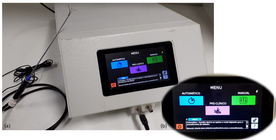
Figura 11 – (A) Protótipo final do equipamento SOFIA com o eletrodo Marina 5H apoiado na lateral esquerda (B) Detalhe da tela interface do software do SOFIA que interagirá com o clínico. Nessa tela estão três botões disponíveis para o protocolo de tratamento escolhido: Automático, Manual ou Pré-clínico (Arquivo pessoal).
