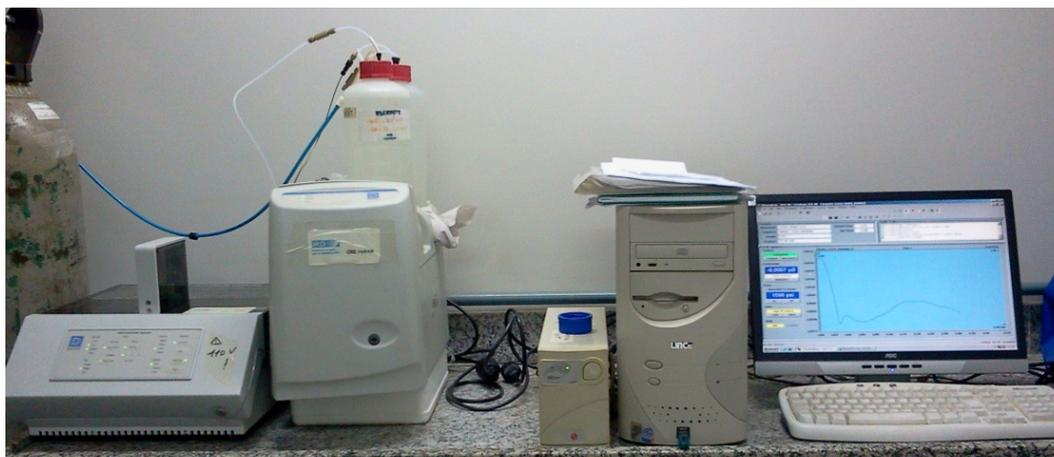
**Figura 3.11- Cromatografia iônica em funcionamento.**
