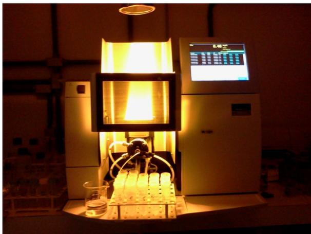
**Figura 3.10- Espectrômetro durante análise.**
