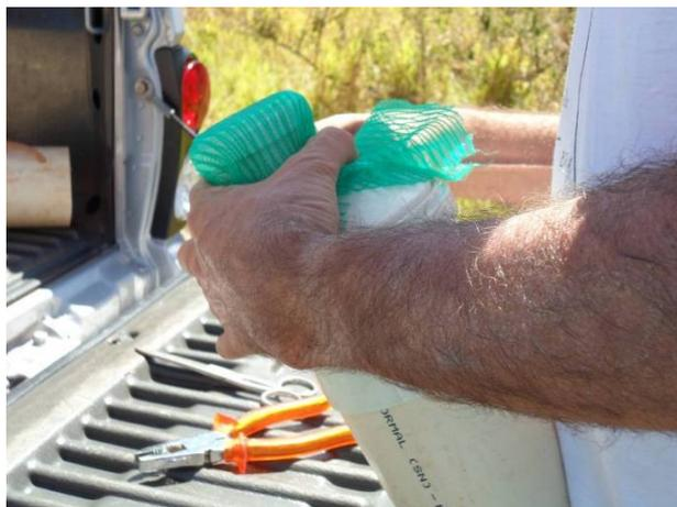
**Figura 3.2-** Detalhe da instalação da tela de *nylon* para contenção do solo e retirada da amostra de percolado.
