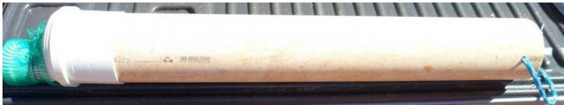
**Figura 3.5 -** Exemplo de tubo utilizado para a montagem das colunas. Na porção inferior foi instalada uma tela de *nylon* para possibilitar a coleta da solução percolada.
