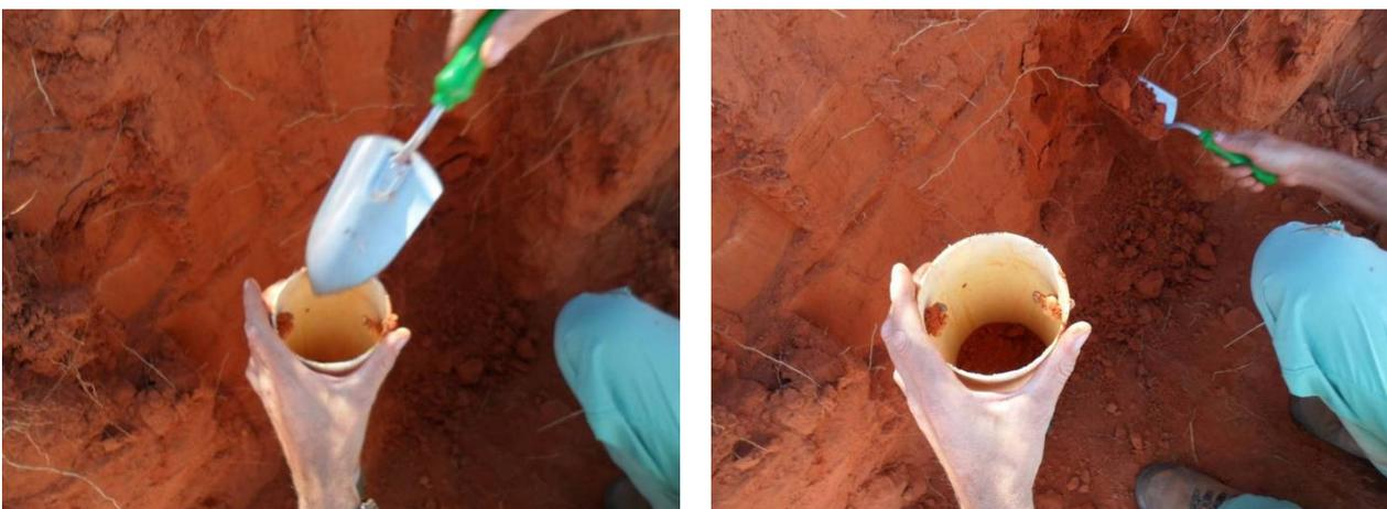
**Figura 3.6 -** Exemplos de retirada da coluna de solo a partir do talude.
