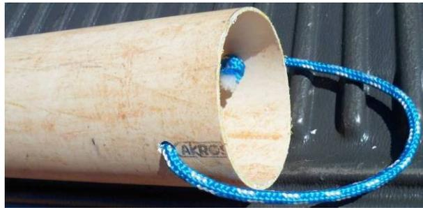
**Figura 3.4-** Detalhe da alça para fixação da coluna acima no nível do terreno, para possibilitar a retirada da amostra em recipiente colocado abaixo da base da coluna.
