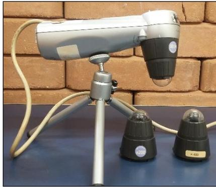
Figura 3.5. Lupa eletrônica AVANTSCOPE
