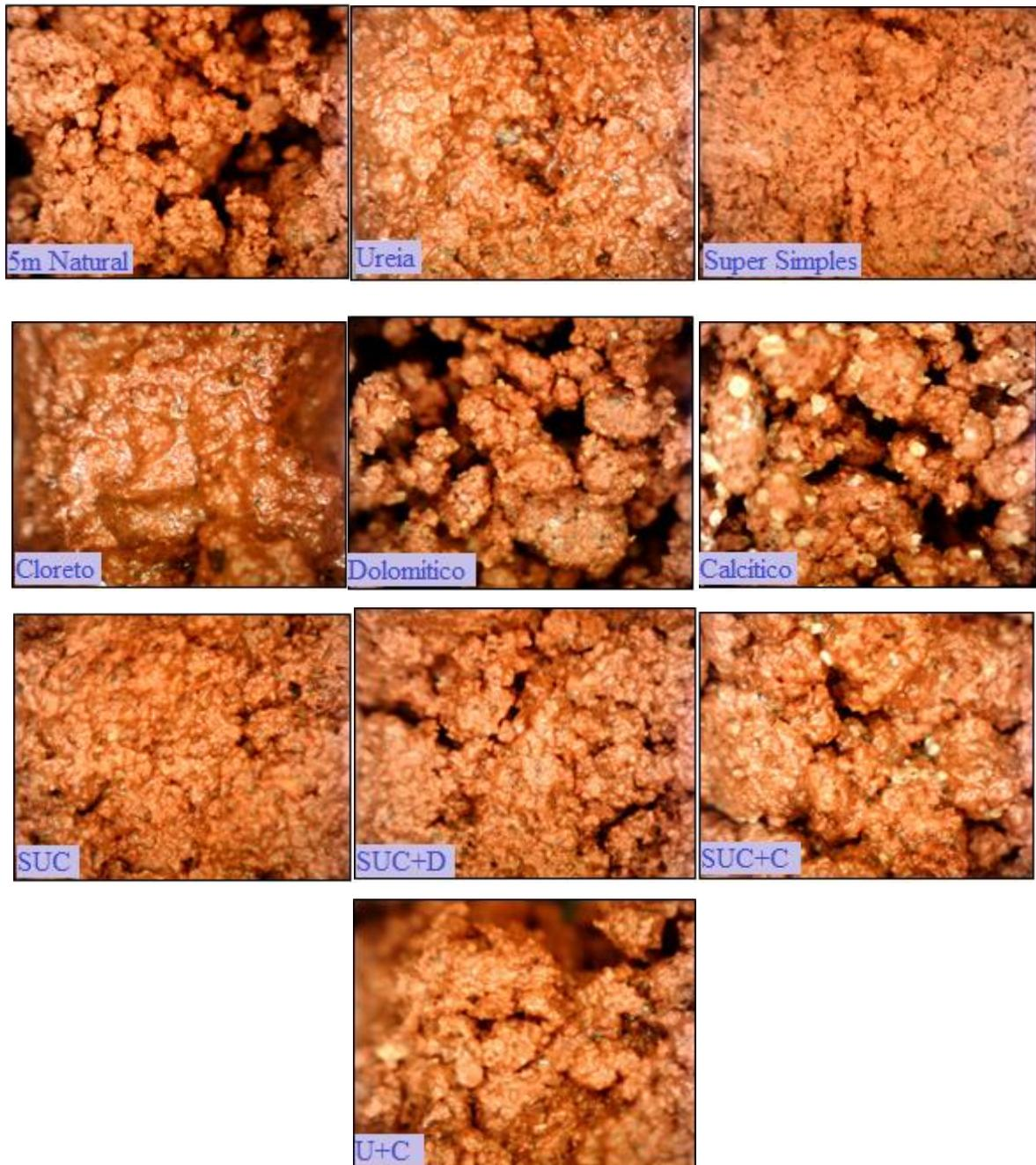
Figura 4.20. Imagens obtidas com a lupa para o solo de 5 m de profundidade misturado com 10% de teor de diferentes aditivos químicos e um tempo de exposição de 24h.
