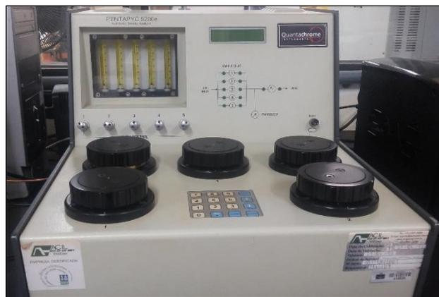
Figura 3.3. Pentapicnômetro Quantachrome
