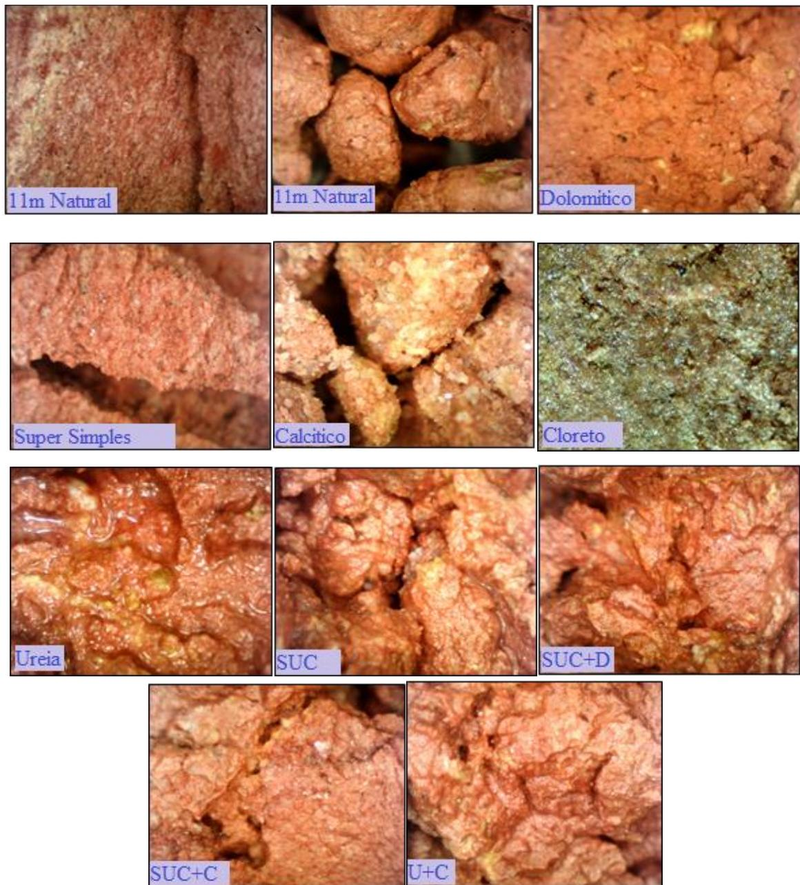
Figura 4.30. Imagens obtidas com a lupa para o solo de 11 m de profundidade misturado com 10% de teor de diferentes aditivos químicos e um tempo de exposição de 24h.
