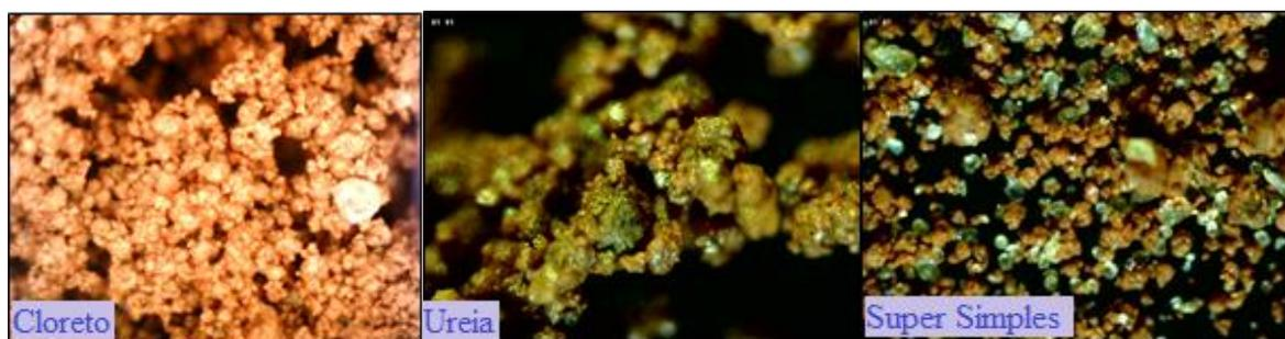
Figura 4.14. Imagens obtidas com a lupa para o solo de 1 m de profundidade misturado com diferentes aditivos químicos e um tempo de exposição de 7 dias.
