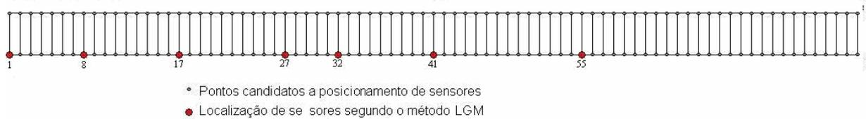
**Figura 7. 33 – Localização dos sensores segundo o método LGM considerando eixo de simetria – Modos verticais – Tabuleiro da ponte pênsil de Clifton.**
