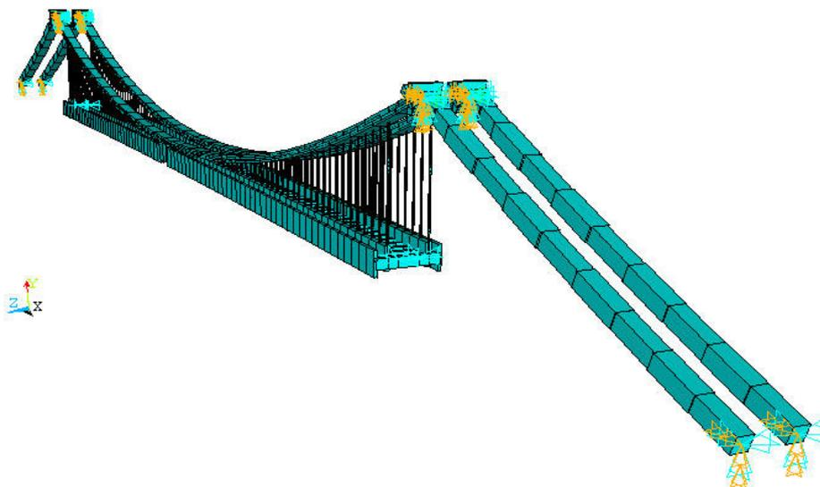
**Figura 7.12 – Modelo inicial em elementos finitos da CSB.**
